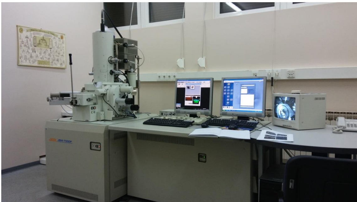
Slika 44. Pretražni elektronski mikroskop Jeol JSM-7000F, Institut Ruđer Bošković, Zavod za kemiju materijala.
