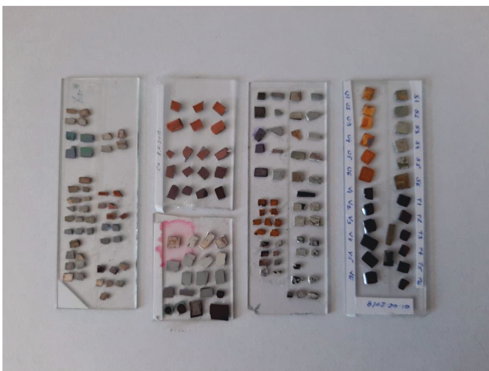
Slika 50. Primjeri SERS uzoraka fiksiranih na predmetna stakalca i spremnih za snimanje na FT-Ramanovom spektrometru.
