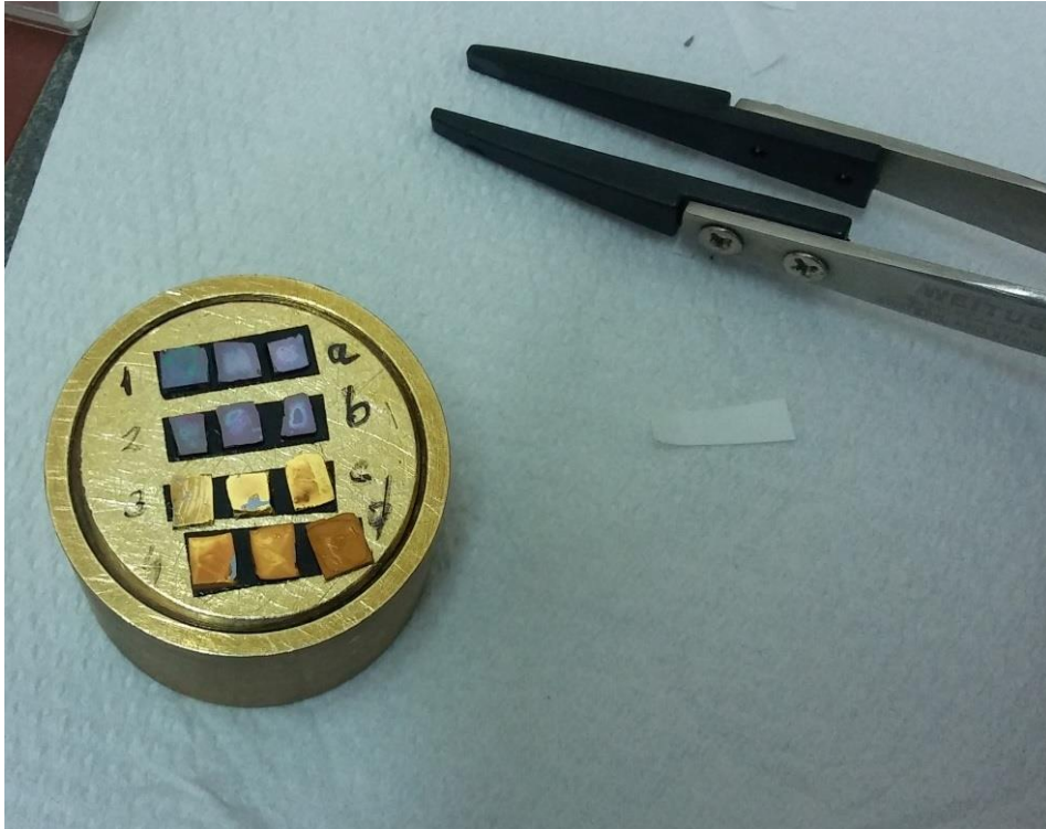
Slika 45. Uzorci srebrom i zlatom obloženih PhC pSi prije snimanja pretražnim elektronskim mikroskopom.
