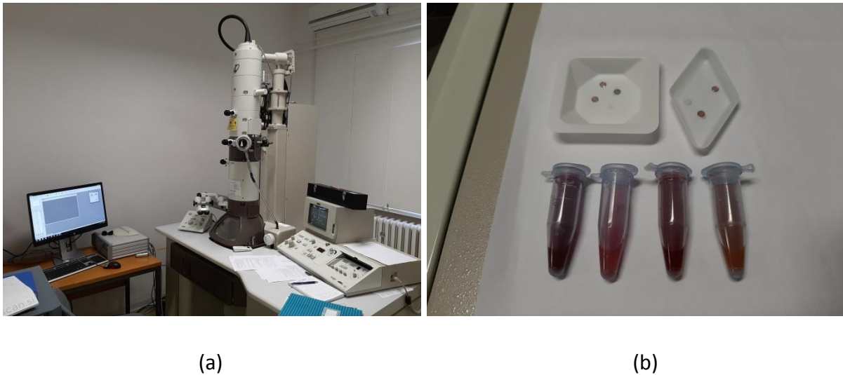
Slika 42. a) Transmisijski elektronski mikroskop JEOL JEM 1010. b) Koloidi zlatnih nanoštapića u različitim stadijima sinteze deponirani na bakrene mrežice.
