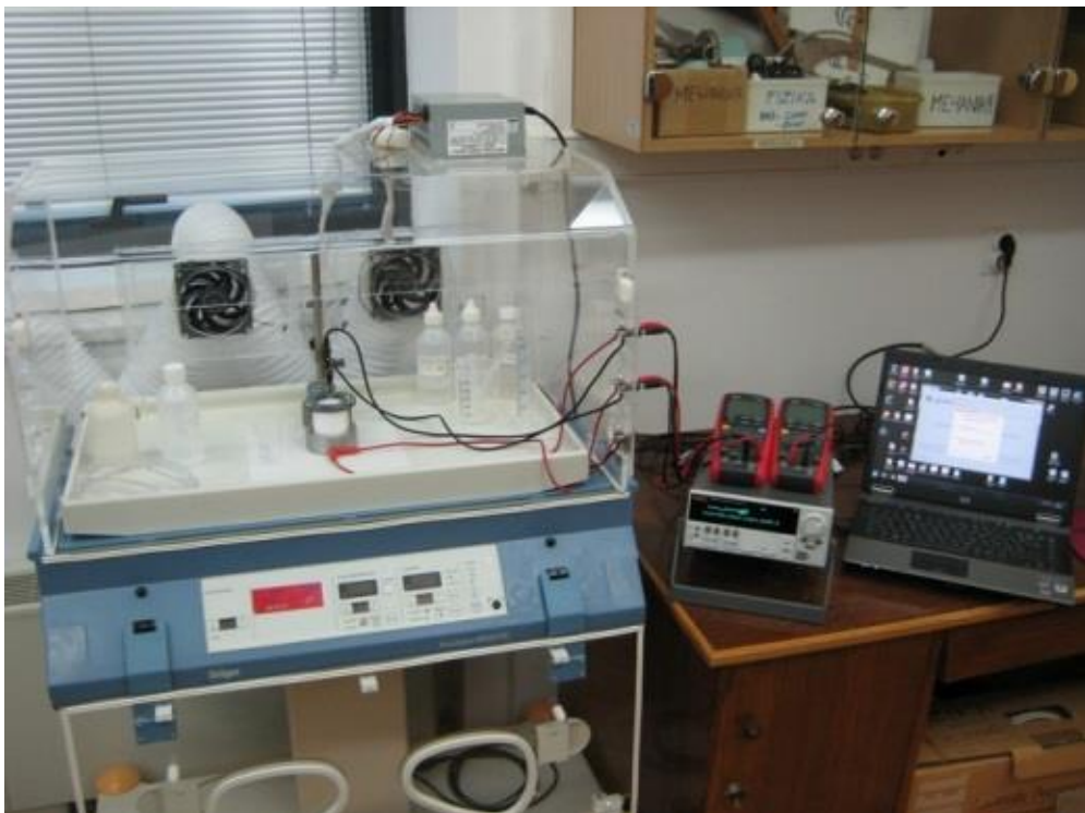
Slika 36. Eksperimentalni postav za izradu poroznog silicija koji, između ostalih elemenata, uključuje i: digestor, anodizacijsku ćeliju, električni izvor Keithley 2601B SourceMeter, multimetre i kompjuter s Labview programom [13].
