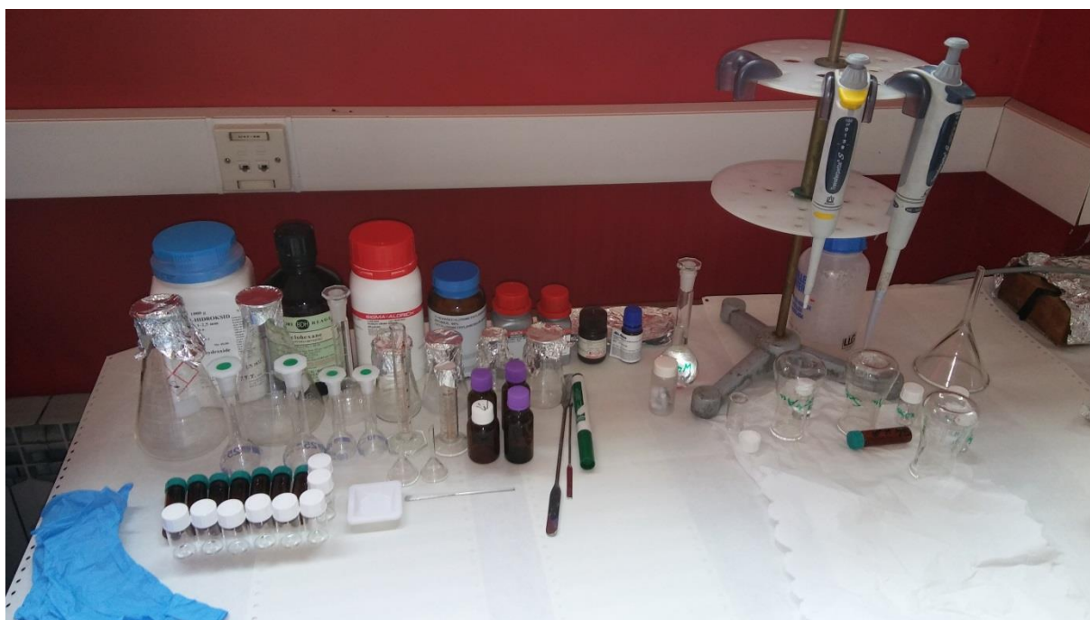
Slika 40. Dio kemijskog pribora korišten za sintezu zlatnih nanoštapica.
