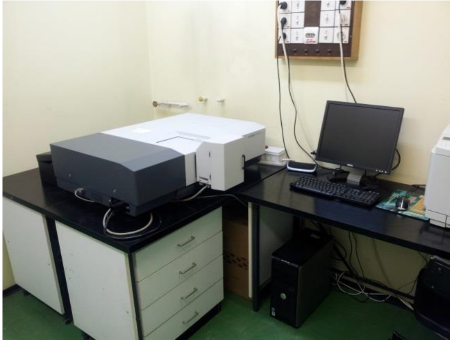
Slika 43. Shimadzu UV-Vis-NIR spektrometar model UV-3600, Institut Ruđer Bošković, Zavod za kemiju materijala [13].
