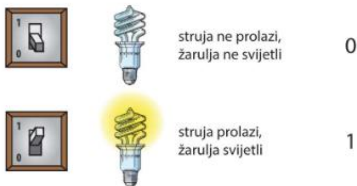
Slika 1.1: Dva stanja sklopke zapisana binarno (vidi [7])
