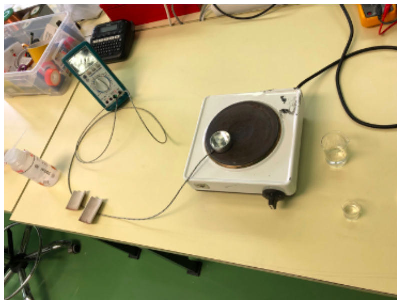
Slika 2.4: Slika prikazuje postav eksperimenta za dio istaživanja Leidenfrostovog efekta.
