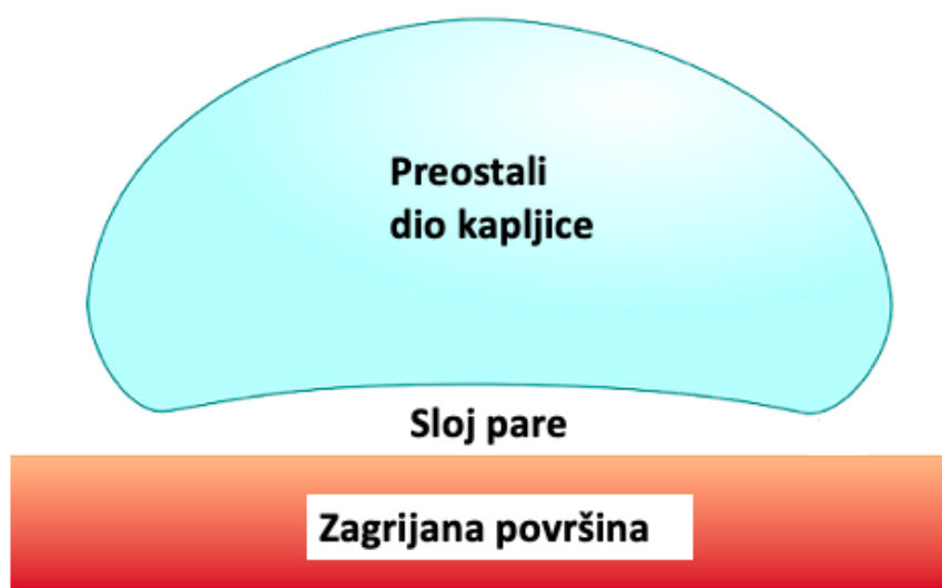
Slika 1.2: Uvećan prikaz Leidenfrostovog efekta na kapljici vode.
