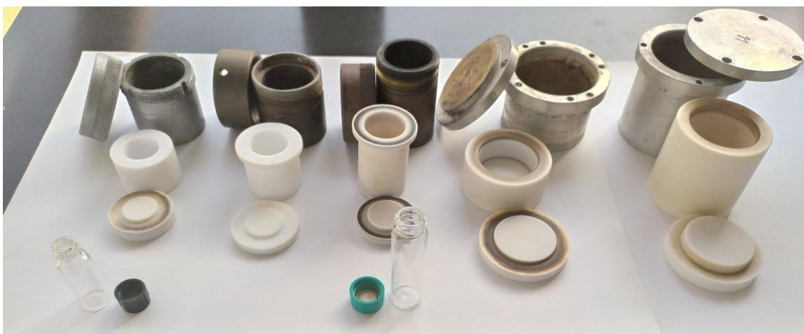
Slika 13. Teflonski autoklavi raznih veličina s aluminijskim, čeličnim i mjedenim plaštevima i staklene posudice s navojnim čepovima.
