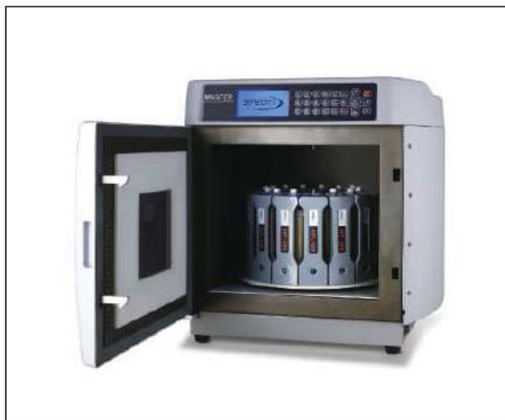
Slika 6. Uređaj za ekstrakciju potpomognutu mikrovalovima. 46
