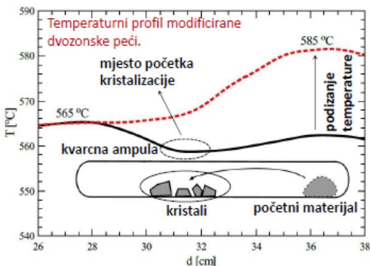
Slika 4.2: Temperaturni profil cijevne dvozonske peći i shematski prikaz sinteze. [9]
