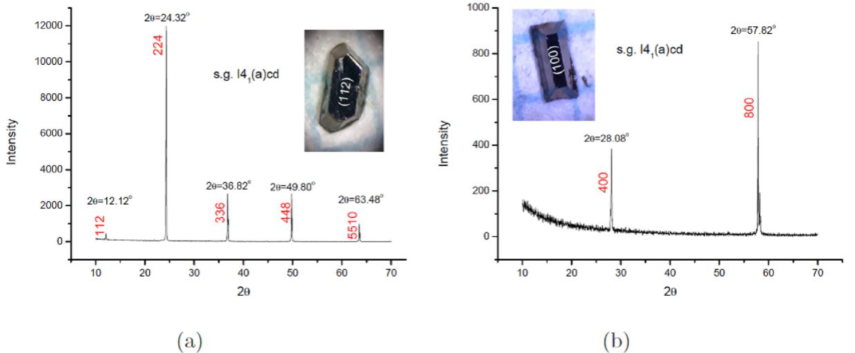
Slika 4.7: XRD difraktogrami dobiveni snimanjem karakterističnih ravnina uzorka  $Cd_3As_2$  difraktometrom za praškaste uzorke. Na fotografijama su označene snimljene ravnine. [9]
