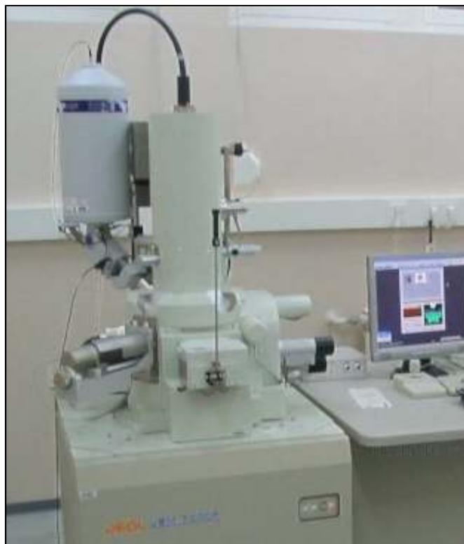
Slika 1a: Izgled transmisijskog elektronskog mikroskopa.
