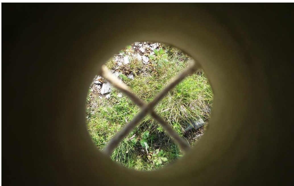
Slika 6. Određivanje pokrovnosti tla metodom kružnog kartonskog cilindra.
