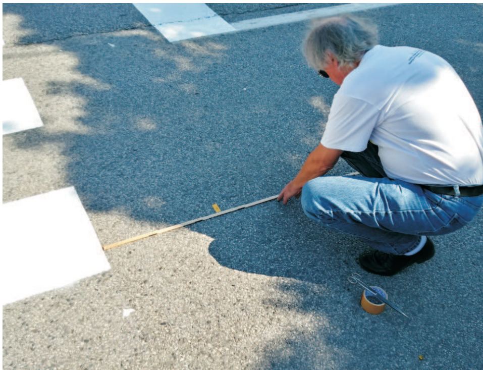
Slika 7.2.2. Uzorkovanje je vršeno pomoću ljepljive trake dimenzija 5 × 2,5 cm
