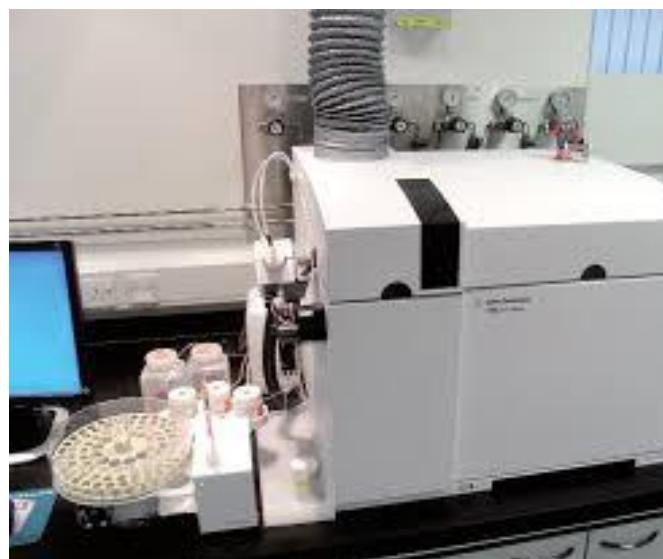
Slika 10. Spektrometar *Agilent 7500cx ICP-MS*.
