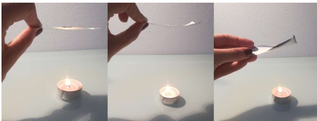
Slika 5.3.2. – Prikaz toplinskog rastezanja različitih materijala
