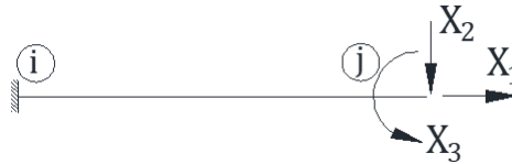
Slika 1.12: Konzola kao osnovni sustav
