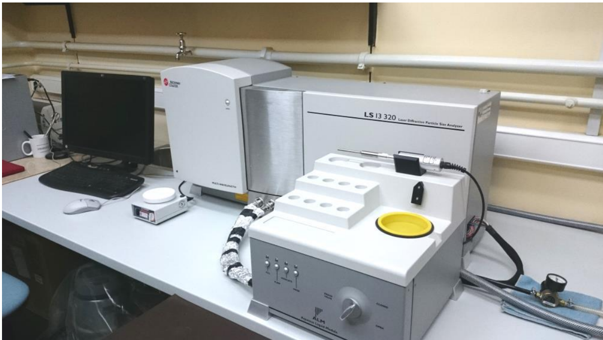
Slika 17. Laserski granulometar (Beckman Coulter LS 13 320), Institut Ruđer Bošković (preuzeto iz Ilijanić, 2016).
