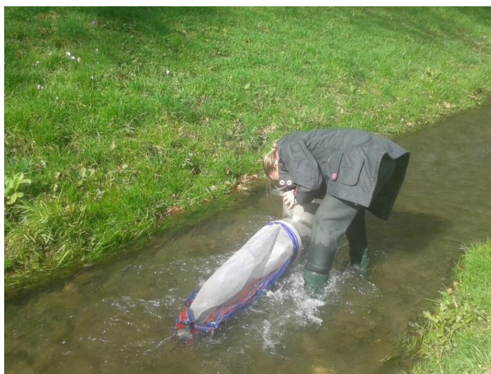
Slika 3. Uzorkovanje makrozoobentosa Hessovim uzorkivačem (foto: Z. Dragun)
