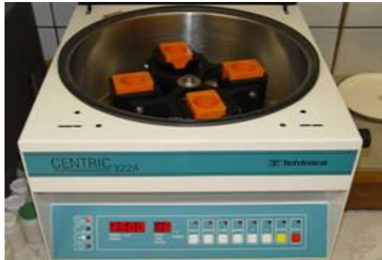
Slika 13. Uređaj za centrifugu CENTRIC 322A (preuzeto s Internetski izvor 7)
