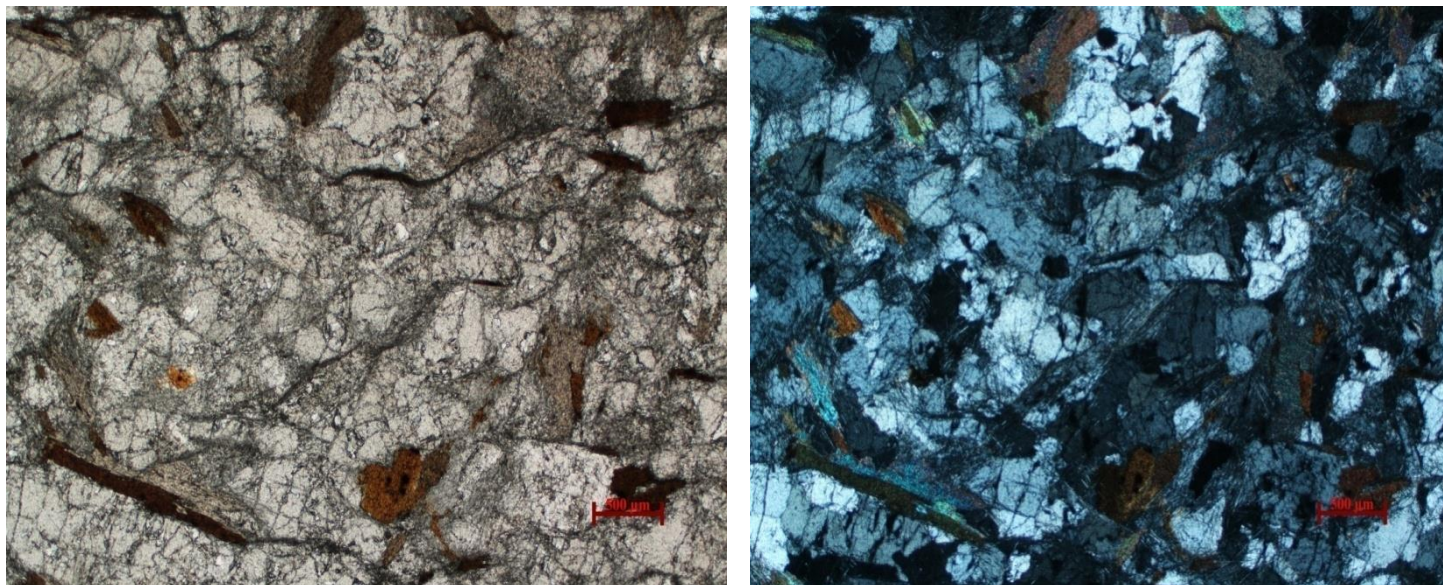
Slika 15. Mikroskopski snimak uzorka 114 (N-, N+) sa mineralima biotita nalik vrpcama. Mjerilo 500 \mu m.
