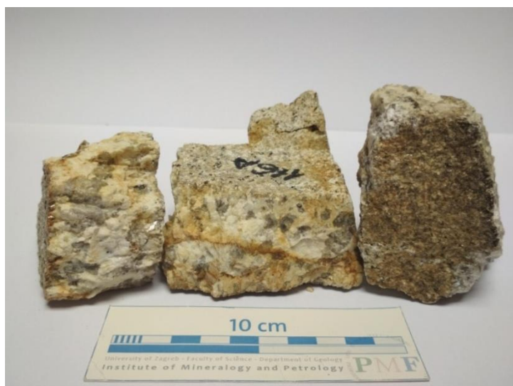
Slika 6. Makroskopski uzorci 116a s mjerilom. Dominiraju kvarc (sivkasto) i feldspati (bijelo).
