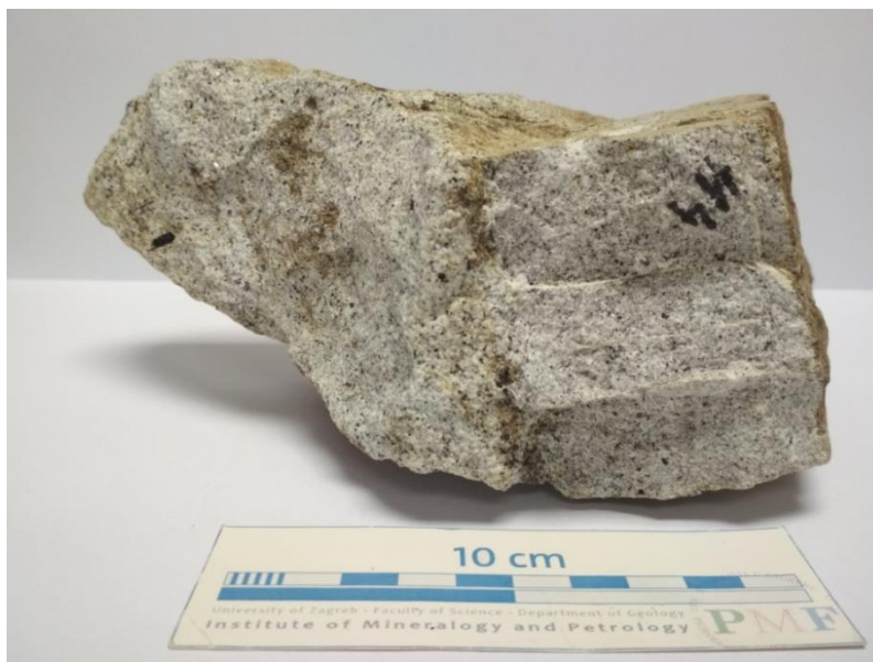
Slika 14. Makroskopski uzorak stijene 114 sa pravilnim do subparalelnim lomom.
