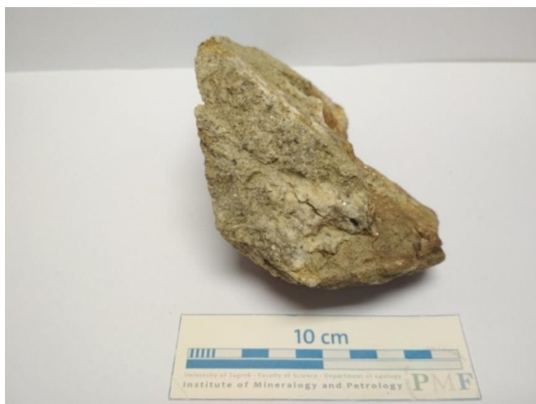
Slika 8. Makroskopski uzorak krupnozrnate stijene 119a s većim leukokratskim mineralima (svjetli).
