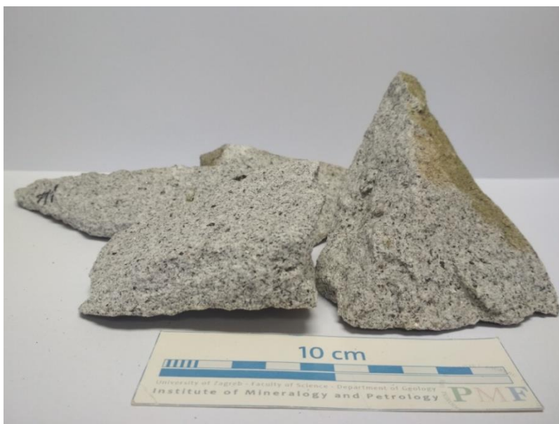
Slika 20. Makroskopski uzorak stijene 111 sa sitnozrnatom osnovom.
