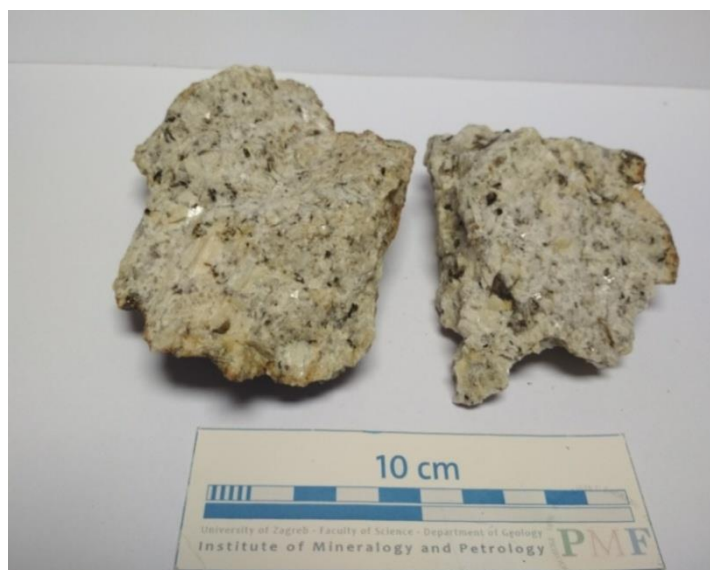
Slika 4. Makroskopski izgled krupnozrnatog uzorka stijene 115a. Od svjetlih faza dominiraju kvarc i feldspati, dok tamna zrna pripadaju biotitu.
