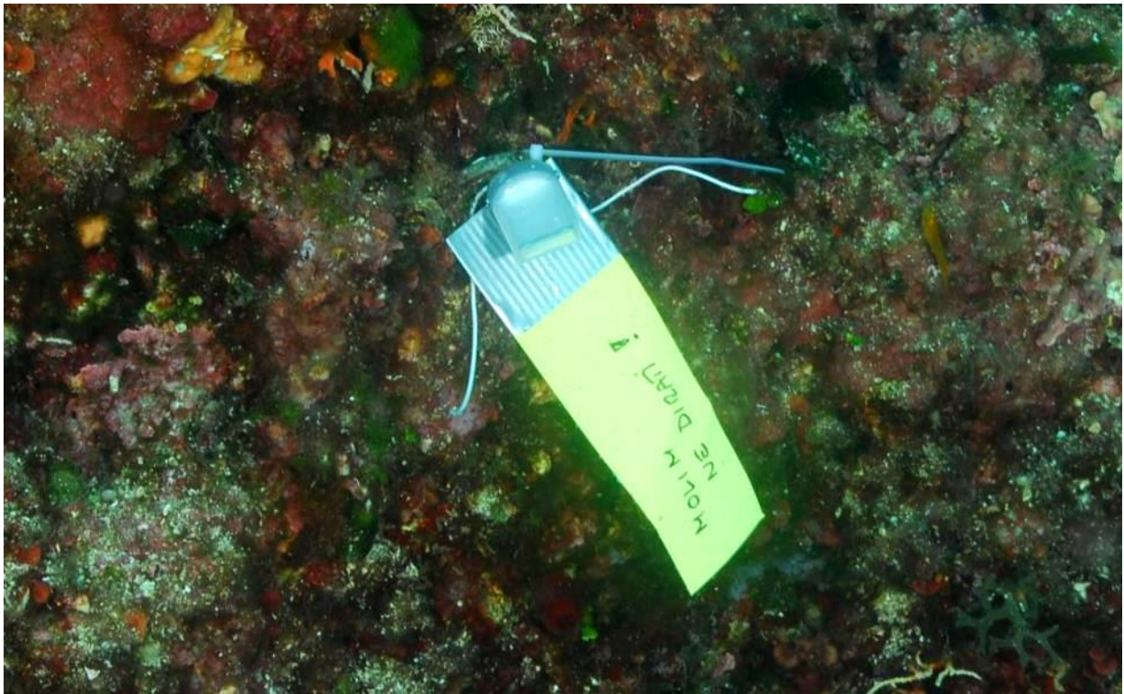
Slika 2. Data logger za mjerenje temperature i količine svjetlosti na postaji Mana (NP Kornati).
