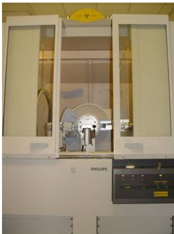
Slika 16. Philips PW3040/60 X'Pert PRO difraktometar
