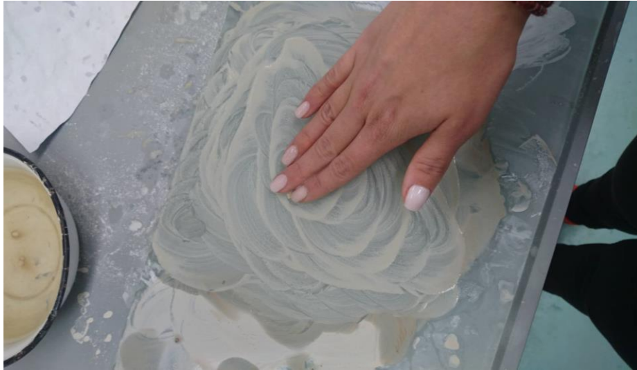
Slika 12. Poliranje preparata korundovim prahom
