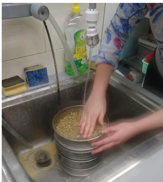
Slika 11. Prosijavanje uzoraka kroz sita
