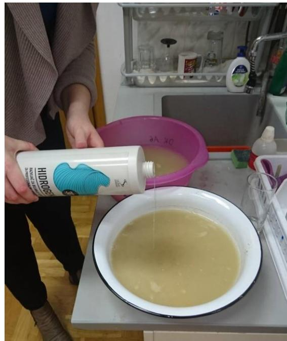
Slika 10. Dodavanje vodikovog peroksida u usitnjeni uzorak s vodom
