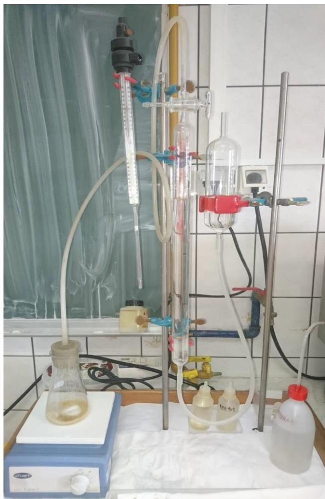
Slika 13. Scheiblerov kalcimetar u laboratoriju MPZ-a
