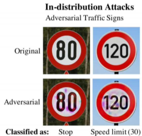
Slika 2.10: Pogrešno klasificirani znakovi za ograničenje brzine na cesti. Slikama u drugom redu je dodan šum te vidimo kako nakon njega mreža krivo klasificira takve slike. Znak za ograničenje brzine od 80 km/h prepoznaje kao znak STOP, a znak za ograničenje brzine od 120 km/h prepoznaje kao ograničenje brzine od 30 km/h.
