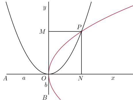
Slika 2.5: Rješenje problema udvostručenja kocke kao presjek dviju parabola
