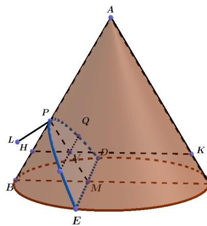
Slika 4.3: Parabola dobivena presjekom stošca i ravnine
