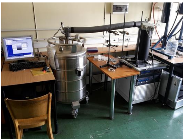
Slika 19. Fotografija sustava za impedancijsku spektroskopiju u Laboratoriju za funkcionalne materijale, IRB.
