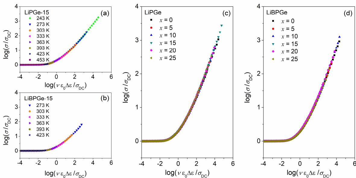
Slika 68. Sidebottomovo skaliranje spektara provodnosti za staklo LiPGe-15 (a), staklo LiBPGGe-15 (b), *supermaster* krivulja provodnosti za seriju A:  $40\text{Li}_2\text{O}-(60-x)\text{P}_2\text{O}_5-x\text{GeO}_2$  (c), *supermaster* krivulja provodnosti za seriju B:  $40\text{Li}_2\text{O}-10\text{B}_2\text{O}_3-(50-x)\text{P}_2\text{O}_5-x\text{GeO}_2$  (d).
