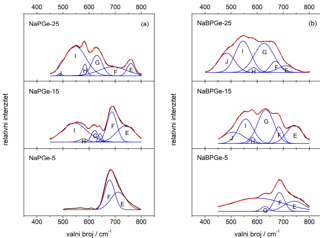
Slika 35. Dekonvolucija Ramanovih spektara u području valnih brojeva  $500 - 800 \text{ cm}^{-1}$  za odabrane uzorke iz serija C (a) i D (b). Eksperimentalna krivulja označena je crnom linijom, plavim linijama su označene pojedinačne vrpce određene dekonvolucijom eksperimentalnih podataka dok crvena krivulja predstavlja ukupni zbroj Gaussovih krivulja.
