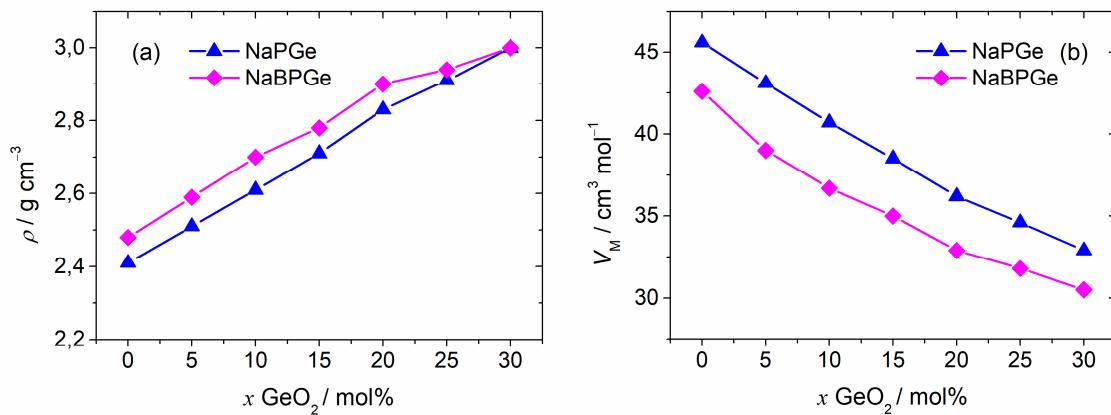
Slika 30. Ovisnost gustoće,  $\rho$ , (a) i molarnog volumena,  $V_M$ , (b) o udjelu dodanog GeO<sub>2</sub> za stakla iz serija C: 40Na<sub>2</sub>O-(60- $x$ )P<sub>2</sub>O<sub>5</sub>- $x$ GeO<sub>2</sub> i D: 40Na<sub>2</sub>O-10B<sub>2</sub>O<sub>3</sub>-(50- $x$ )P<sub>2</sub>O<sub>5</sub>- $x$ GeO<sub>2</sub>.
