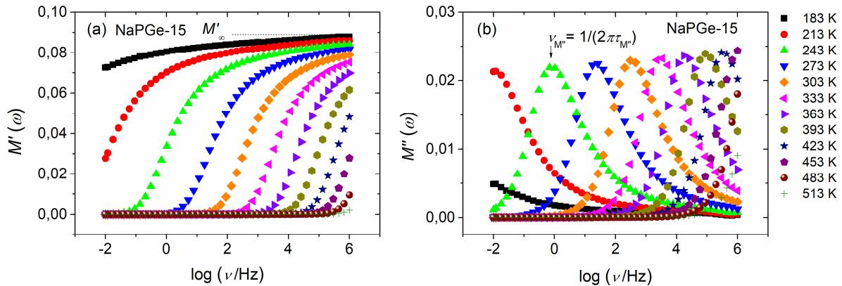
Slika 80. Frekvencijske ovisnosti realnog i imaginarnog dijela električnog modula,  $M'(\omega)$  i  $M''(\omega)$ , za staklo NaPGe-15 na različitim temperaturama.
