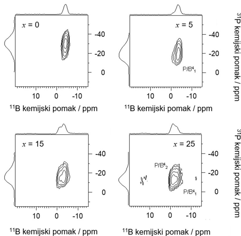
Slika 41.  $^{11}\text{B}/^{31}\text{P}$  heteronuklearni korelacijski NMR spektari: 2D  $^{11}\text{B}/^{31}\text{P}$  mape za odabrana stakla iz serije B: LiBPGe-0, LiBPGe-5, LiBPGe-15 i LiBPGe-25.
