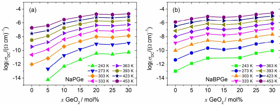
Slika 75. Ovisnost istosmjerne provodnosti,  $\sigma_{DC}$ , o udjelu  $\text{GeO}_2$  na različitim temperaturama za stakla iz serija C:  $40\text{Na}_2\text{O}-(60-x)\text{P}_2\text{O}_5-x\text{GeO}_2$  (a) i D:  $40\text{Na}_2\text{O}-10\text{B}_2\text{O}_3-(50-x)\text{P}_2\text{O}_5-x\text{GeO}_2$  (b).
