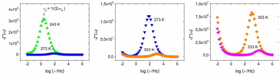
Slika 62. Frekvencijske ovisnosti imaginarnog dijela impedancije,  $Z''(\omega)$ , za staklo LiPGe-15 na različitim temperaturama.
