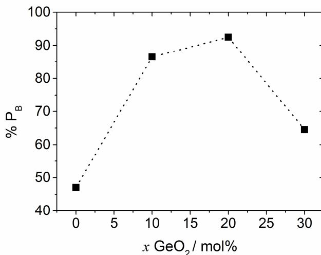
Slika 50. Ovisnost udjela fosfora vezanog za boratne jedinice, %  $P_B$ , o udjelu  $\text{GeO}_2$  za stakla iz serije D:  $40\text{Na}_2\text{O}-10\text{B}_2\text{O}_3-(50-x)\text{P}_2\text{O}_5-x\text{GeO}_2$ .
