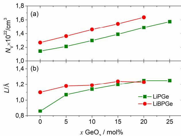
Slika 69. Trendovi ovisnosti gustoće nositelja naboja,  $N_V$  (a) i Sidebottomove duljine,  $L$  (b) o udjelu GeO<sub>2</sub> za stakla iz serija A: 40Li<sub>2</sub>O–(60– $x$ )P<sub>2</sub>O<sub>5</sub>– $x$ GeO<sub>2</sub> i B: 40Li<sub>2</sub>O–10B<sub>2</sub>O<sub>3</sub>–(50– $x$ )P<sub>2</sub>O<sub>5</sub>– $x$ GeO<sub>2</sub>.
