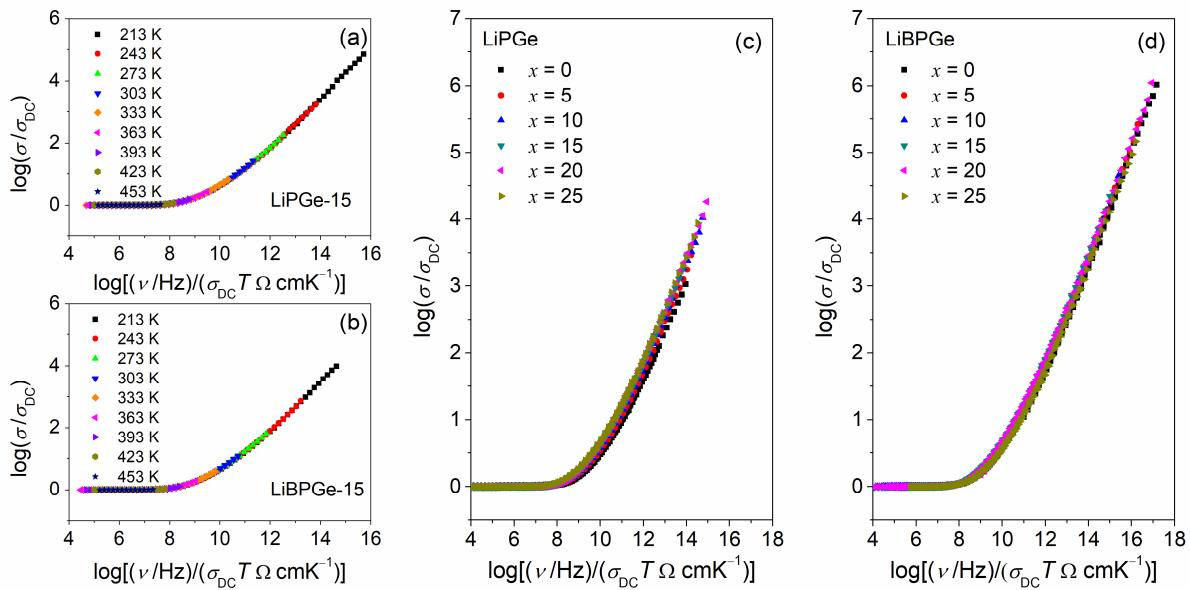
Slika 66. Summerfieldovo skaliranje spektara provodnosti za staklo LiPGe-15 (a), staklo LiBPGe-15 (b), preklapanje *master* krivulja provodnosti svih stakala iz serije A:  $40\text{Li}_2\text{O}-(60-x)\text{P}_2\text{O}_5-x\text{GeO}_2$  (c), preklapanje *master* krivulja provodnosti svih stakala iz serije B:  $40\text{Li}_2\text{O}-10\text{B}_2\text{O}_3-(50-x)\text{P}_2\text{O}_5-x\text{GeO}_2$  (d).
