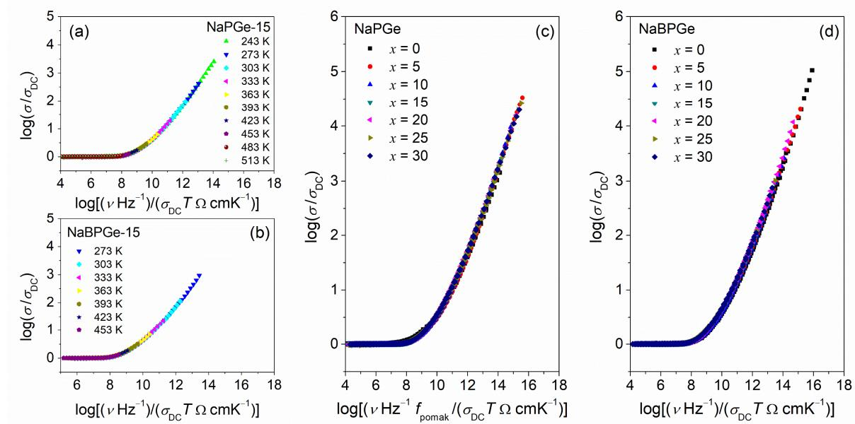
Slika 83. Summerfieldovo skaliranje za staklo NaPGe-15 (a), staklo NaBPG-15 (b), preklapanje *master* krivulja provodnosti koristeći faktor pomaka za seriju C: 40Na<sub>2</sub>O–(60–x)P<sub>2</sub>O<sub>5</sub>–xGeO<sub>2</sub> (c), preklapanje *master* krivulja provodnosti za seriju D: 40Na<sub>2</sub>O–10B<sub>2</sub>O<sub>3</sub>–(50–x)P<sub>2</sub>O<sub>5</sub>–xGeO<sub>2</sub> (d).
