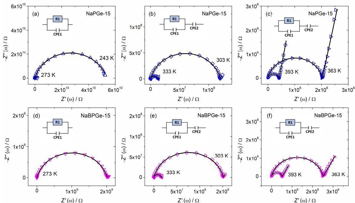
Slika 72. Impedancijski spektrovi u kompleksnoj ravnini za uzorke NaPGe-15 (a-c) i NaBPGGe-15 (d-f) na različitim temperaturama. Simbolima je označena eksperimentalna impedancija dok crna linija označava teorijsku impedanciju.
