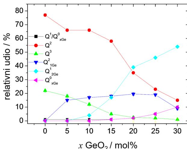
Slika 44. Razvoj relativnih udjela (%)  $Q^n$  jedinica određenih dekompozijom  $^{31}\text{P}$  MAS NMR spektara za stakla iz serije C: 40Na<sub>2</sub>O-(60-x)P<sub>2</sub>O<sub>5</sub>-xGeO<sub>2</sub>.
