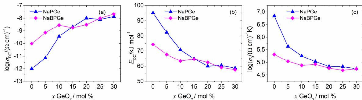
Slika 77. Ovisnosti istosmjerne provodnosti,  $\sigma_{DC}$ , na 303 K (a), aktivacijske energije,  $E_{DC}$  (b), i predeksponencijskog faktora,  $\sigma_0$  (c), o udjelu GeO<sub>2</sub> za stakla iz serija C: 40Na<sub>2</sub>O–(60–x)P<sub>2</sub>O<sub>5</sub>–xGeO<sub>2</sub> i D: 40Na<sub>2</sub>O–10B<sub>2</sub>O<sub>3</sub>–(50–x)P<sub>2</sub>O<sub>5</sub>–xGeO<sub>2</sub>.
