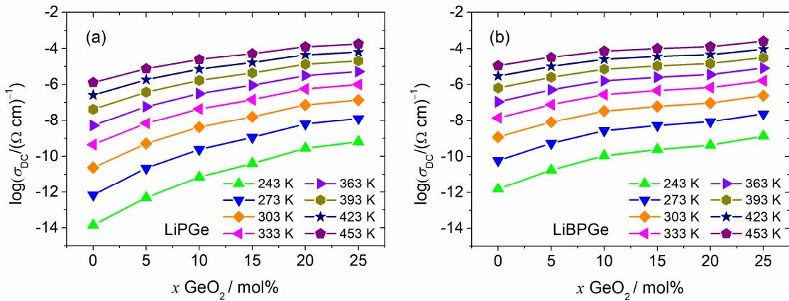
Slika 55. Ovisnost istosmjerne provodnosti,  $\sigma_{DC}$ , o udjelu  $\text{GeO}_2$  na različitim temperaturama za stakla iz serija A:  $40\text{Li}_2\text{O}-(60-x)\text{P}_2\text{O}_5-x\text{GeO}_2$  (a) i B:  $40\text{Li}_2\text{O}-10\text{B}_2\text{O}_3-(50-x)\text{P}_2\text{O}_5-x\text{GeO}_2$  (b).
