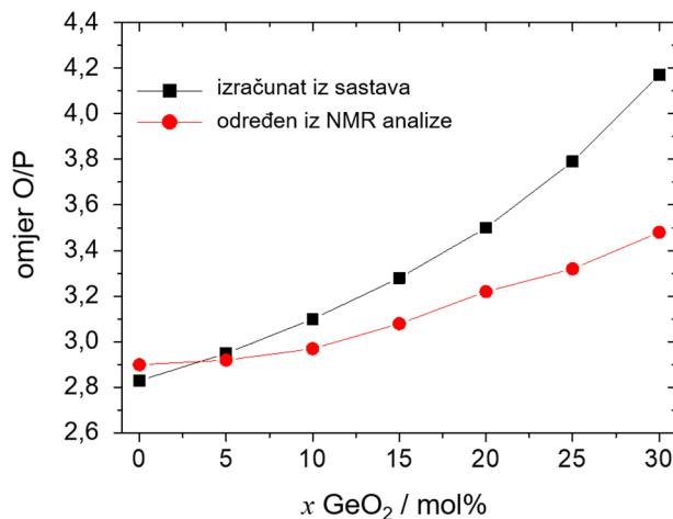
Slika 45. Omjeri O/P određeni iz sastava stakala (kvadrati) te iz  $^{31}\text{P}$  MAS NMR analize (krugovi) za stakla iz serije C:  $40\text{Na}_2\text{O}-(60-x)\text{P}_2\text{O}_5-x\text{GeO}_2$ .
