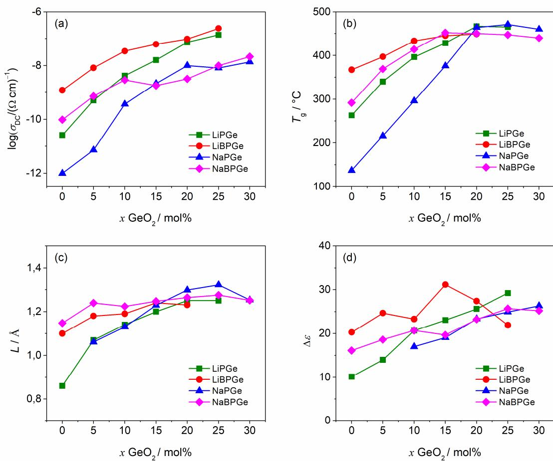
Slika 86. Trendovi ovisnosti vrijednosti DC provodnosti,  $\sigma_{\text{DC}}$ , na 303 K (a), staklišta,  $T_g$  (b), Sidebottomove duljine,  $L$  (c) i dielektrične snage,  $\Delta\varepsilon$  (d) o udjelu  $\text{GeO}_2$  za litijeve i natrijeve serije stakala.
