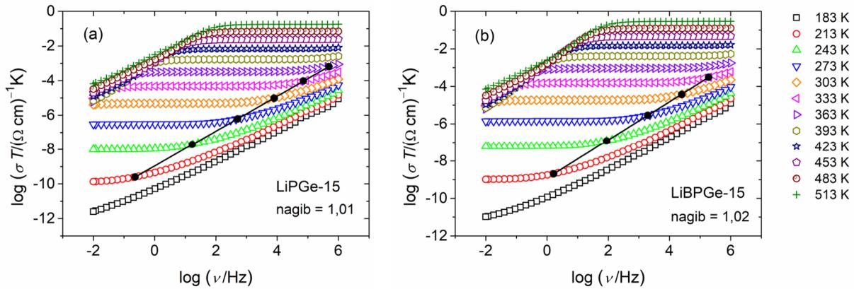
Slika 65. Spektri provodnosti za stakla LiPGe-15 (a) i LiBPG-15 (b). S punim kružićima označene su frekvencije početka disperzije provodnosti,  $\nu_0$ , definirane prema  $\sigma'(\nu_0) = 2\sigma_{DC}$ . Pravac je dobiven linearnom regresijom.
