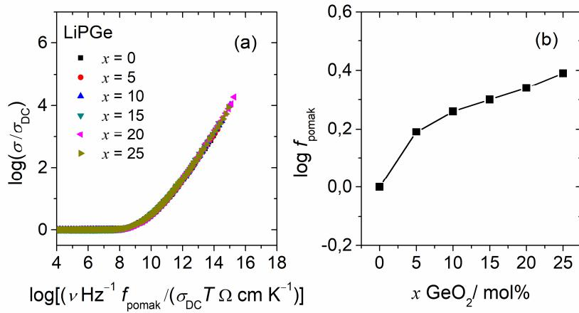
Slika 67. Summerfieldovo skaliranje; *supermaster* krivulja provodnosti dobivena korištenjem faktora pomaka,  $f_{\text{pomak}}$  (a), ovisnost logaritma faktora pomaka o udjelu  $\text{GeO}_2$  (b) za stakla iz serije A:  $40\text{Li}_2\text{O}-(60-x)\text{P}_2\text{O}_5-x\text{GeO}_2$ .
