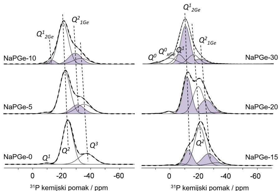
Slika 43.  $^{31}\text{P}$  MAS NMR spektri snimljeni na 9,4 T za stakla iz serije C:  $40\text{Na}_2\text{O}-(60-x)\text{P}_2\text{O}_5-x\text{GeO}_2$ . Označeno su označene fosfatne jedinice vezane za atome germanija.
