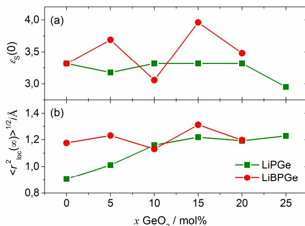
Slika 71. Trendovi ovisnosti vrijednosti *plateau-a* skalirane permitivnosti,  $\varepsilon_s(0)$ , i prostornog dosega lokaliziranih skokova iona,  $\langle r_{\text{loc}}^2(\infty) \rangle^{1/2}$ , o udjelu GeO<sub>2</sub> za stakla iz serija A: 40Li<sub>2</sub>O–(60–x)P<sub>2</sub>O<sub>5</sub>–xGeO<sub>2</sub> i B: 40Li<sub>2</sub>O–10B<sub>2</sub>O<sub>3</sub>–(50–x)P<sub>2</sub>O<sub>5</sub>–xGeO<sub>2</sub>.
