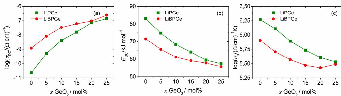
Slika 57. Ovisnosti istosmjernih provodnosti,  $\sigma_{DC}$ , na 303 K (a), aktivacijskih energija,  $E_{DC}$  (b), i predeksponencijskog faktora,  $\sigma_0$  (c), o udjelu  $\text{GeO}_2$  za stakla iz serija A:  $40\text{Li}_2\text{O}-(60-x)\text{P}_2\text{O}_5-x\text{GeO}_2$  i B:  $40\text{Li}_2\text{O}-10\text{B}_2\text{O}_3-(50-x)\text{P}_2\text{O}_5-x\text{GeO}_2$ .
