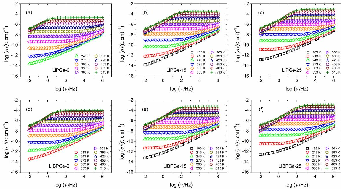
Slika 54. Frekvencijska ovisnost provodnosti za odabrana stakla ( $x = 0, 15$  i  $25$  mol%) iz serija A:  $40\text{Li}_2\text{O}-(60-x)\text{P}_2\text{O}_5-x\text{GeO}_2$  (a-c) i B:  $40\text{Li}_2\text{O}-10\text{B}_2\text{O}_3-(50-x)\text{P}_2\text{O}_5-x\text{GeO}_2$  (d-f).
