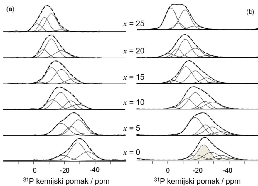
Slika 42.  ${}^{31}\text{P}$  projekcije 2D D-HMQC mapa (a), dekompozicija 1D  ${}^{31}\text{P}$  MAS NMR spektara (b) za stakla iz serije B:  $40\text{Li}_2\text{O}-10\text{B}_2\text{O}_3-(50-x)\text{P}_2\text{O}_5-x\text{GeO}_2$ ; osjenčano su označene fosfatne jedinice na koje nije vezan bor.
