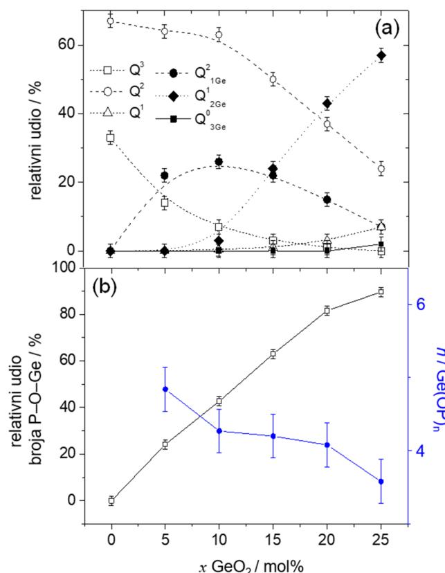
Slika 37. Razvoj relativnih udjela (%)  $Q^n$  jedinica određenih dekompozijom  $^{31}\text{P}$  MAS NMR spektara (a); relativni udio broja P–O–Ge veza određen iz  $^{31}\text{P}$  NMR analize te broj  $\text{P}^{5+}$  iona vezanih P–O–Ge vezama za  $\text{Ge}^{4+}$  ion (b) za stakla iz serije A:  $40\text{Li}_2\text{O}-(60-x)\text{P}_2\text{O}_5-x\text{GeO}_2$ .
