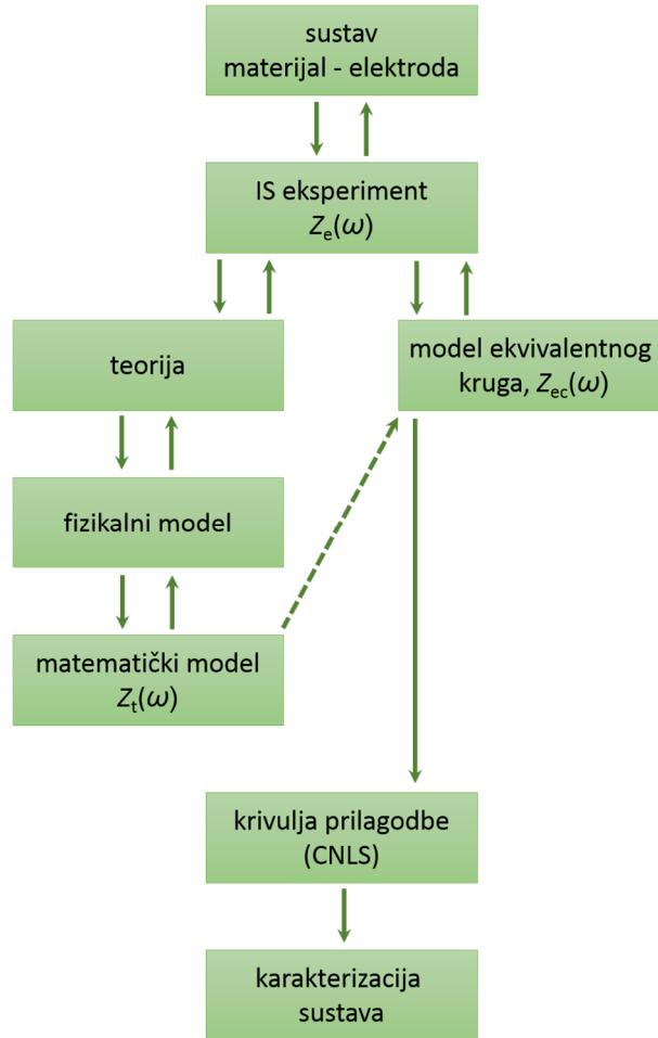
Slika 24. Shematski prikaz određivanja svojstva materijala IS-om.<sup>82</sup>
