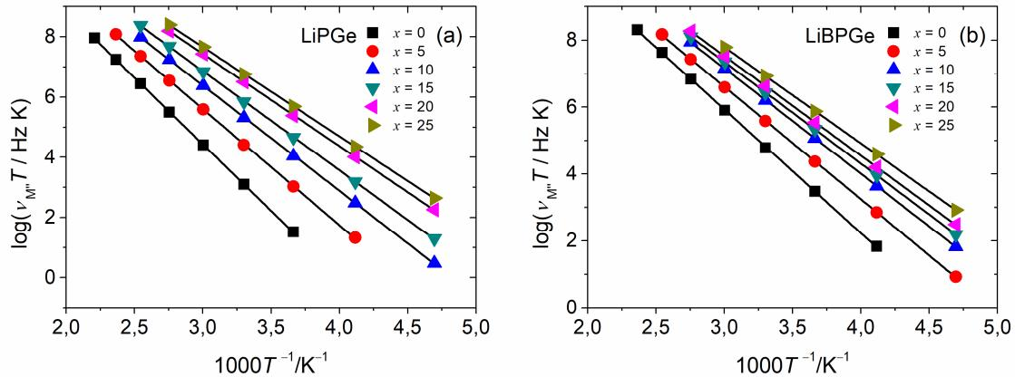
Slika 61. Ovisnost  $\log(\nu_{M''}T)$  o recipročnoj temperaturi,  $1/T$ , za stakla iz serija A: 40Li<sub>2</sub>O–(60– $x$ )P<sub>2</sub>O<sub>5</sub>– $x$ GeO<sub>2</sub> (a) i B: 40Li<sub>2</sub>O–10B<sub>2</sub>O<sub>3</sub>–(50– $x$ )P<sub>2</sub>O<sub>5</sub>– $x$ GeO<sub>2</sub> (b).
