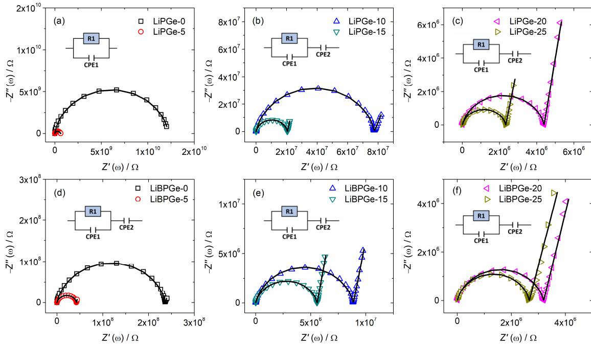
Slika 53. Impedancijski spektri u kompleksnoj ravnini za stakla različitih sastava iz serija A:  $40\text{Li}_2\text{O}-(60-x)\text{P}_2\text{O}_5-x\text{GeO}_2$  (a-c) i B:  $40\text{Li}_2\text{O}-10\text{B}_2\text{O}_3-(50-x)\text{P}_2\text{O}_5-x\text{GeO}_2$  (d-e) mjereni na 303 K. Simbolima je označena eksperimentalna impedancija dok crna linija označava teorijsku impedanciju.
