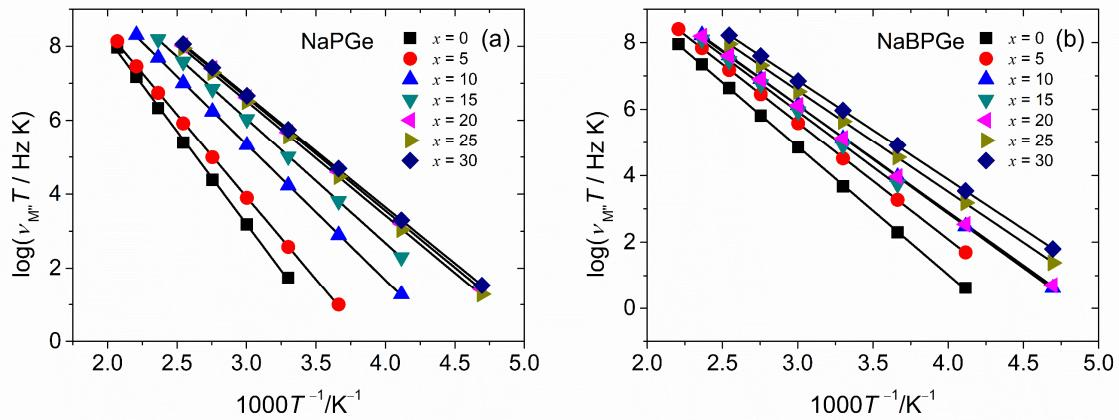
Slika 81. Ovisnost  $\log(\nu_M'' T)$  o recipročnoj temperaturi,  $1/T$ , za stakla iz serija C: 40Na<sub>2</sub>O–(60–x)P<sub>2</sub>O<sub>5</sub>–xGeO<sub>2</sub> (a) i D: 40Na<sub>2</sub>O–10B<sub>2</sub>O<sub>3</sub>–(50–x)P<sub>2</sub>O<sub>5</sub>–xGeO<sub>2</sub> (b).
