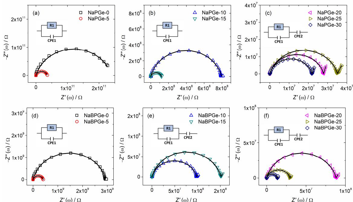
Slika 73. Impedancijski spektri u kompleksnoj ravnini za stakla različitih sastava iz serija C:  $40\text{Na}_2\text{O}-(60-x)\text{P}_2\text{O}_5-x\text{GeO}_2$  (a-c) i D:  $40\text{Na}_2\text{O}-10\text{B}_2\text{O}_3-(50-x)\text{P}_2\text{O}_5-x\text{GeO}_2$  (d-f) mjereni na 303 K. Simbolima je označena eksperimentalna impedancija dok crna linija označava teorijsku impedanciju.
