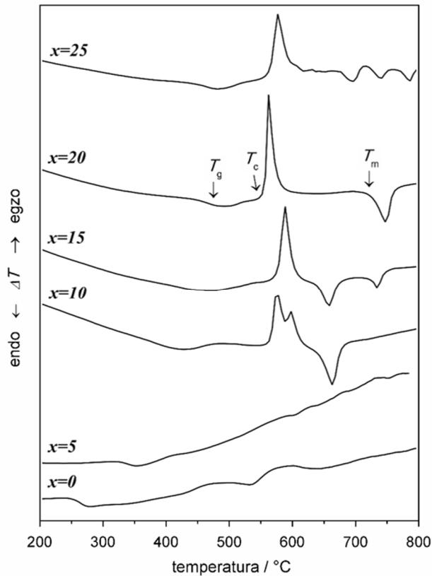
Slika 28. DSC krivulje za stakla iz serije A:  $40\text{Li}_2\text{O}-(60-x)\text{P}_2\text{O}_5-x\text{GeO}_2$ .
