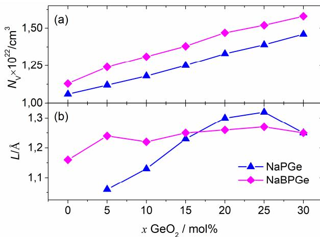
Slika 85. Trendovi ovisnosti gustoće nositelja naboja,  $N_V$  (a) i Sidebottomove duljine,  $L$  (b) o udjelu GeO<sub>2</sub> za stakla iz serija C: 40Na<sub>2</sub>O-(60-x)P<sub>2</sub>O<sub>5</sub>-xGeO<sub>2</sub> i D: 40Na<sub>2</sub>O-10B<sub>2</sub>O<sub>3</sub>-(50-x)P<sub>2</sub>O<sub>5</sub>-xGeO<sub>2</sub>.
