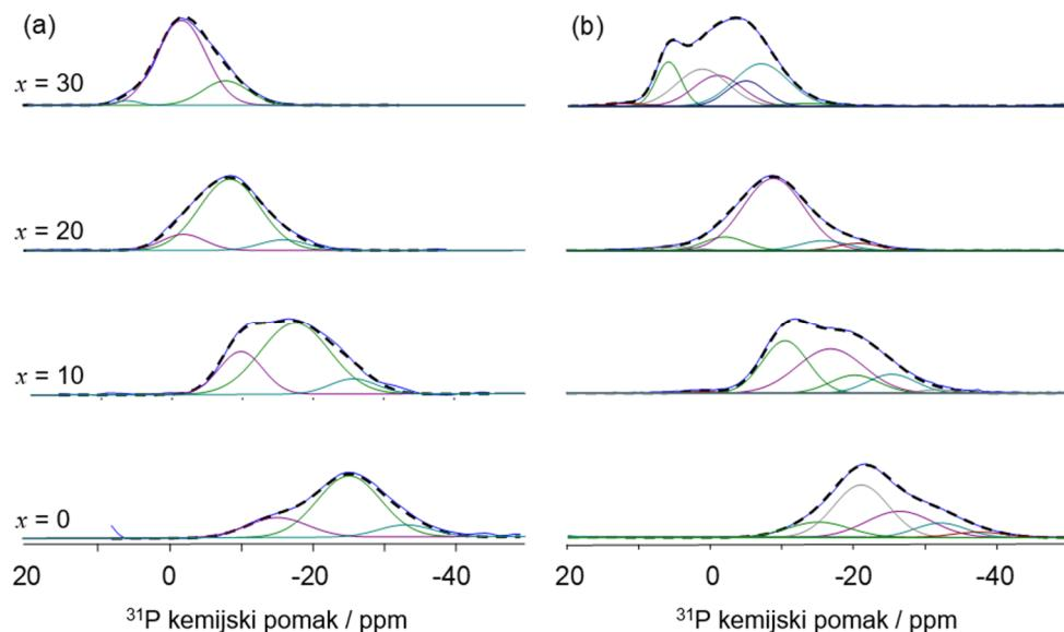
Slika 49. Dekompozicija  $^{31}\text{P}$  projekcije 2D D-HMQC mapa (a), dekompozicija 1D  $^{31}\text{P}$  MAS NMR spektara (b) za stakla iz serije D:  $40\text{Na}_2\text{O}-10\text{B}_2\text{O}_3-(50-x)\text{P}_2\text{O}_5-x\text{GeO}_2$ .
