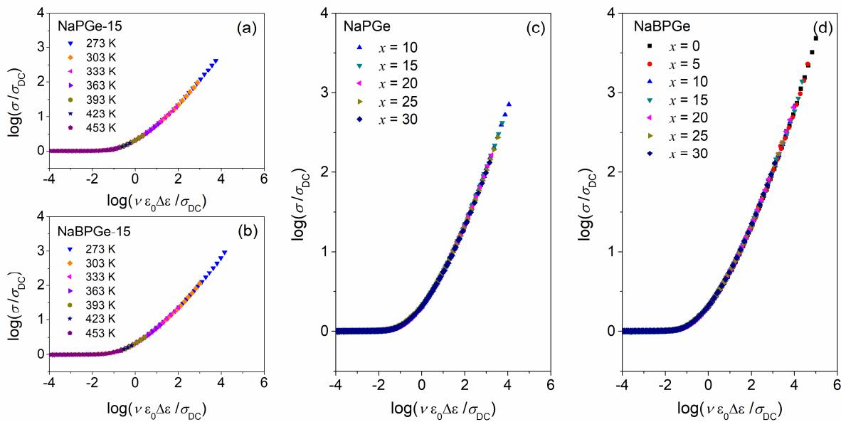
Slika 84. Sidebottomovo skaliranje za staklo NaPGe-15 (a), staklo NaBPGe-15 (b), *supermaster* krivulja provodnosti za seriju C: 40Na<sub>2</sub>O-(60-x)P<sub>2</sub>O<sub>5</sub>-xGeO<sub>2</sub> (c), *supermaster* krivulja provodnosti za seriju D: 40Na<sub>2</sub>O-10B<sub>2</sub>O<sub>3</sub>-(50-x)P<sub>2</sub>O<sub>5</sub>-xGeO<sub>2</sub> (d).
