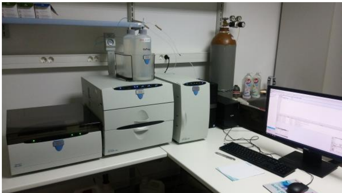
Slika 22. Dionex ICS 5000 ionski kormatograf
