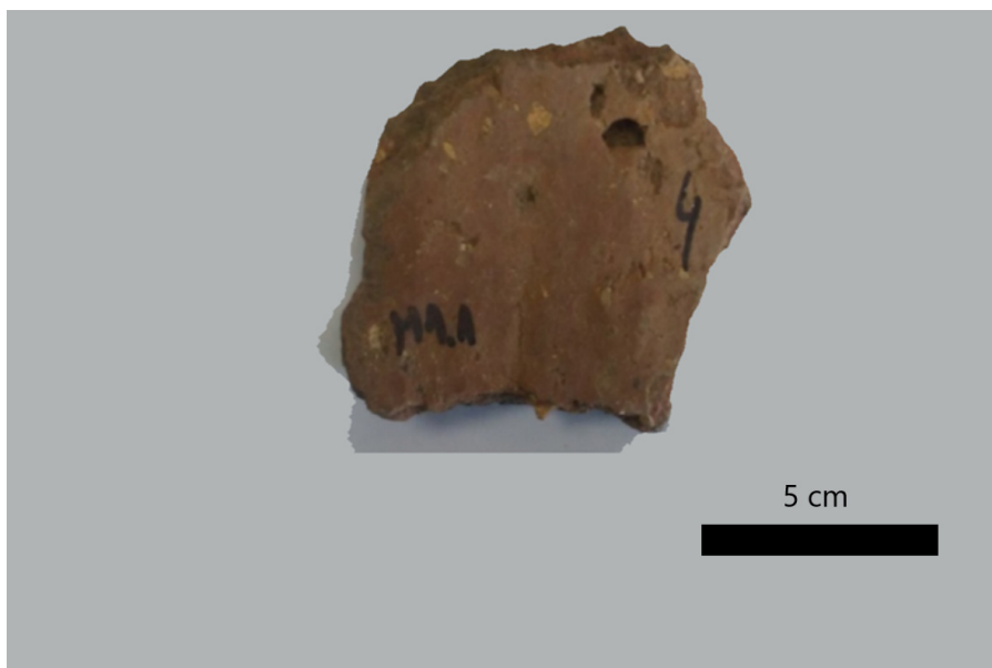
Slika 6.1. Uzorak opeke s porama (M1.1). Makedonija, Alinci
