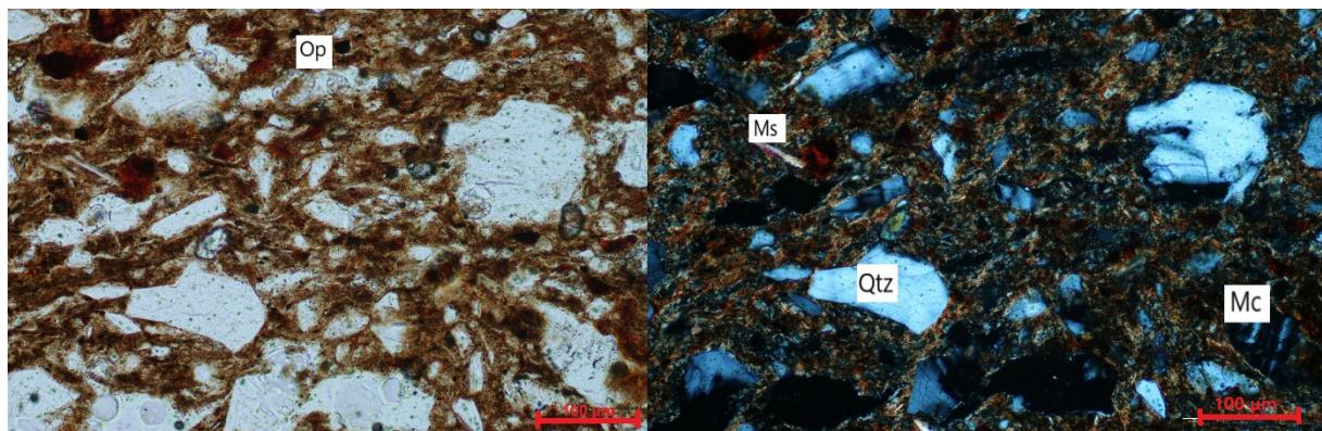
Slika 6.2.4. Uzorak M5, na lijevoj strani je uzorak bez analizatora gdje je vidljiv smeđi matriks, a s desne strane je prikazan s uključenim analizatorom. Uočena su zrna mikroklina (Mc), kvarca (Qtz), muskovita (Ms) i opakih minerala (Op)
