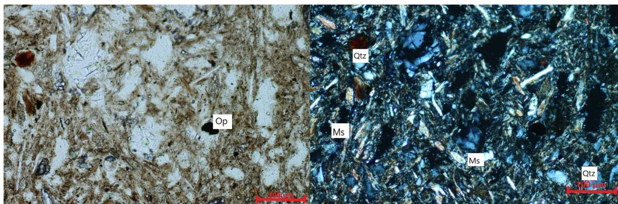
Slika 6.13. . Uzorak M2 na lijevoj slici prikazuje uzorak bez analizatora, gdje je su jasno vidljivi štapičasti i opaci minerali, a na desnoj strani su vidljivi minerali kvarca (Qtz), muskovita (Ms).
