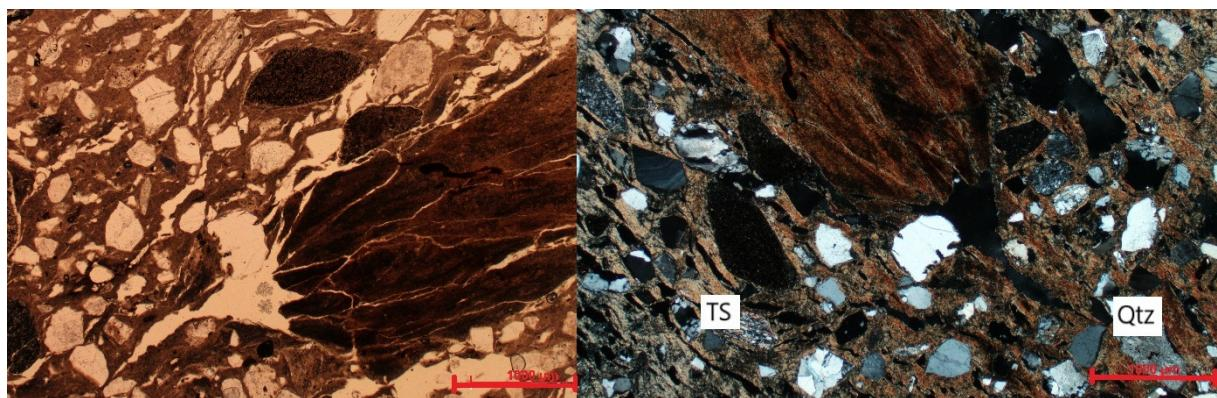
Slika 6.2.12. Prikazuje uzorak KS4, slika s lijeve strane je uslikana bez analizatora, a slika s desne strane je uslikana s analizatorom. Razaznaju se zrna minerala kvarca (Qtz) i fragmenti stjene (TS)
