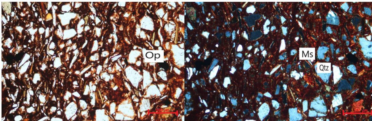
Slika 6.15. Mikroskopski uzorak B6 s lijeve je bez analizatora i pokazuje zrna podjednake veličine uronjene u crveni matriks. S desne strane je prikazan uzorak bez analizatora. Uočena su mineralna zrna muskovita (Ms), kvarca (Qtz) i opakih minerala (Op).
