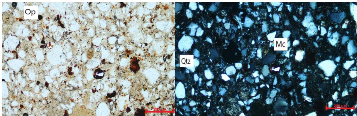
Slika 6.2.5. Mikroskopski uzorak B3 s lijeve je bez analizatora i pokazuje zrna podjednake veličine usitnjene u ružičasti matriks. S desne strane je prikazan uzorak bez analizatora. Uočena su mineralna zrna mikroklina (Mc), kvarca (Qtz) i opakih minerala (Op)
