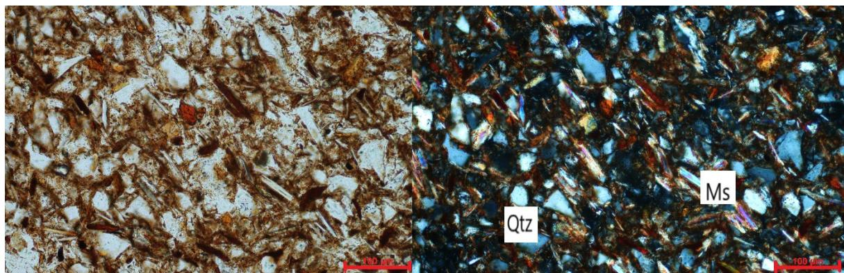
Slika 6.18. Prikazuje uzorak KC2, slika s lijeve strane je uslikana bez analizatora, a slika s desne strane je uslikana s analizatorom. Razaznaju se zrna minerala Muskovita (Ms) i kvarca (Qtz)
