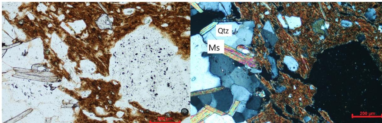
Slika 6.14 Uzorak M3 je s lijeve strane bez analizatora, od mineralnih faza su vidljivi muskovit (MS) i kvarc (Qtz), te smeđi matriks, na desnoj slici je uzorak s analizatorom.
