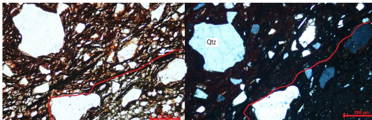
Slika 6.16. Mikroskopski uzorak B8 s lijeve strane je bez anlizatora, a s desne strane s analizatorom. Crvena linija označava granicu promjene boje u matriksu.
