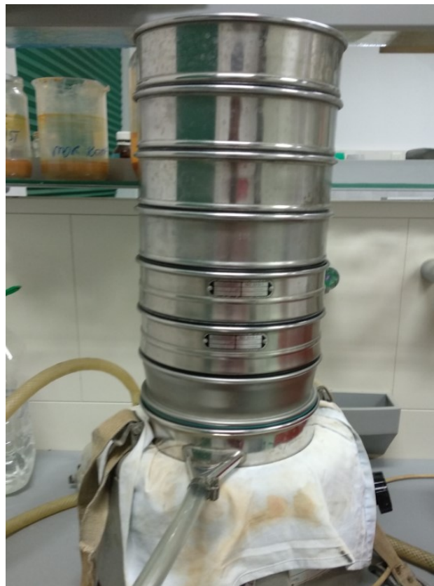
Slika 12. Aparatura za mokro sijanje (fotografirao Ivan Mikičić)
