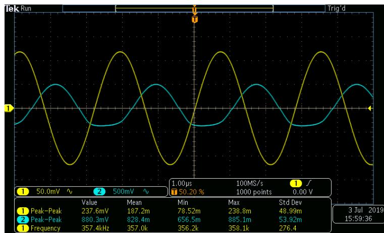
Slika 3.4: Vremenski prikaz napona na diodi (plavo) i ulaznog napona (žuto) od 0.250 V sa zavojnicom induktiviteta 2/3 mH.
