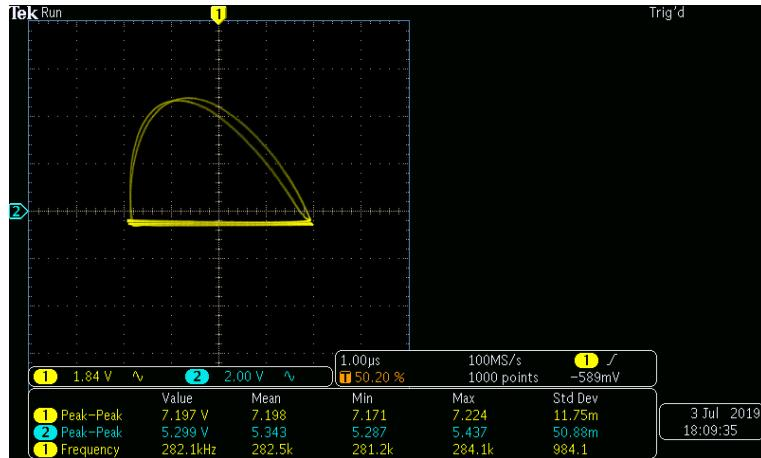
Slika 3.47: X-Y prikaz napona na diodi i ulaznog napona od 7.04 V sa zavojnjicom induktiviteta 2 mH.
