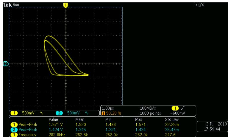
Slika 3.35: X-Y prikaz napona na diodi i ulaznog napona od 1.58 V sa zavojnjicom induktiviteta 2 mH.
