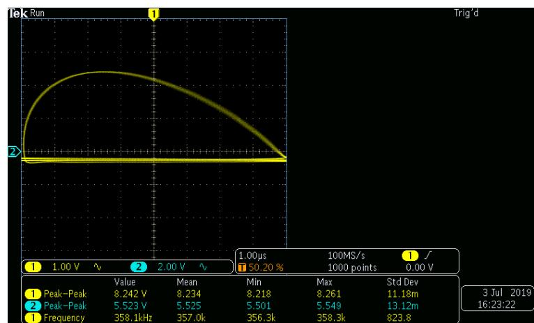
Slika 3.20: X-Y prikaz napona na diodi i ulaznog napona od 8.03 V sa zavojnjicom induktiviteta 2/3 mH.
