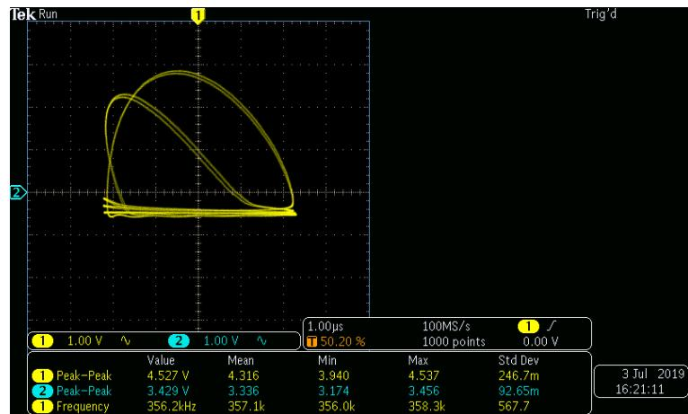
Slika 3.14: X-Y prikaz napona na diodi i ulaznog napona od 4.47 V sa zavojnjicom induktiviteta 2/3 mH.
