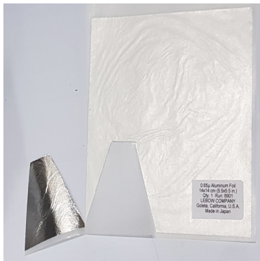
(c) Odvajanje aluminijske folije
