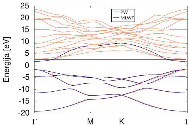
**Slika 9.4 Struktura energetskih vrpcija grafana dobivena wannierizacijom sustava ( $E_F = 0\text{eV}$ ). Narančastom bojom označene su vrpcije dobivene metodom ravnih valova, a plavom one dobivene bazom MLWF**
