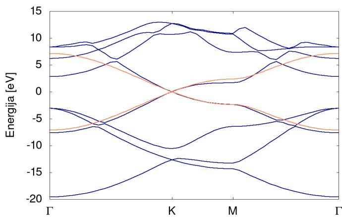
Slika 3.2 Usporedba DFT i TBA strukture vrpcu
