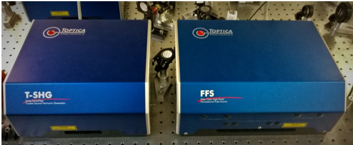
Slika 3.7: Femtosekundni laser Toptica Photonics Femtofiber Scientific FFS (desno) te jedinica za generiranje drugog harmonika (lijevo). Preuzeto iz [23].
