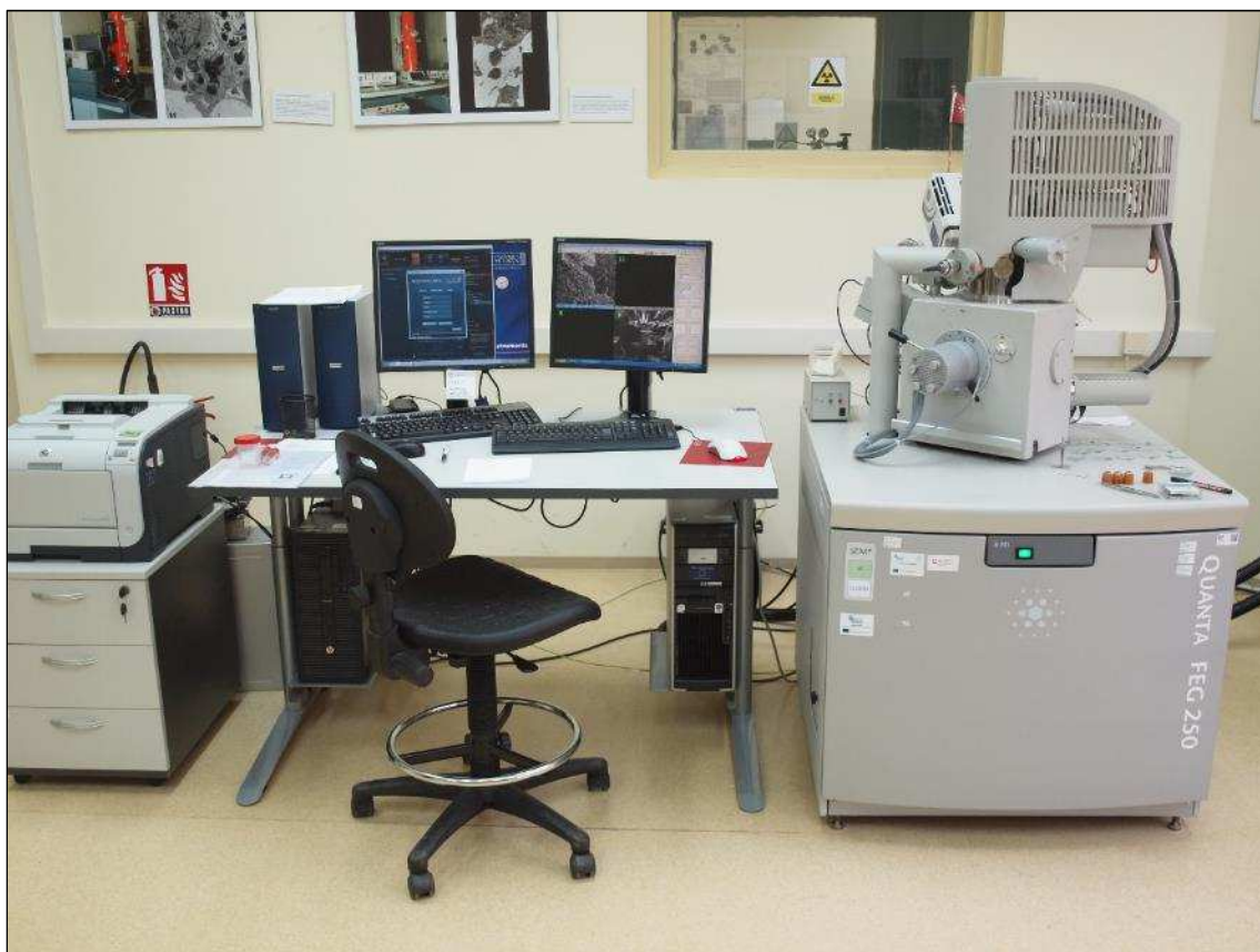
Slika 9. Skenirajući elektronski mikroskop Quanta FEG 250 FEI u Centru za Istraživanje materijala Istarske županije METRIS.
