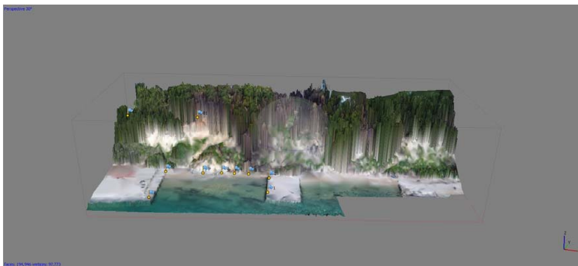
Slika 12. Pogrešno spajanje točaka pri izradi 3D mreže (Agisoft PhotoScan, 2020).
