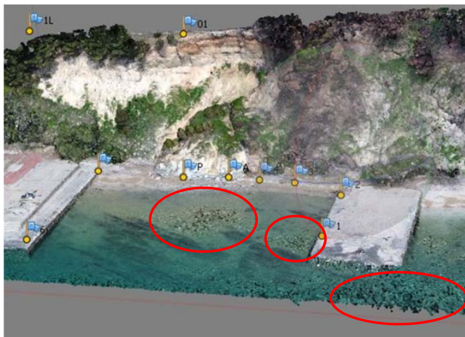
Slika 14. Primjer pogrešne interpretacije reljefa (Agisoft PhotoScan, 2020).
