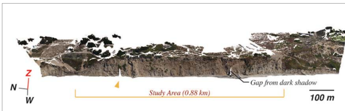
Slika 11. Praznine u oblaku točaka zbog neravnomjernog svjetla (Warrick i sur., 2017).
