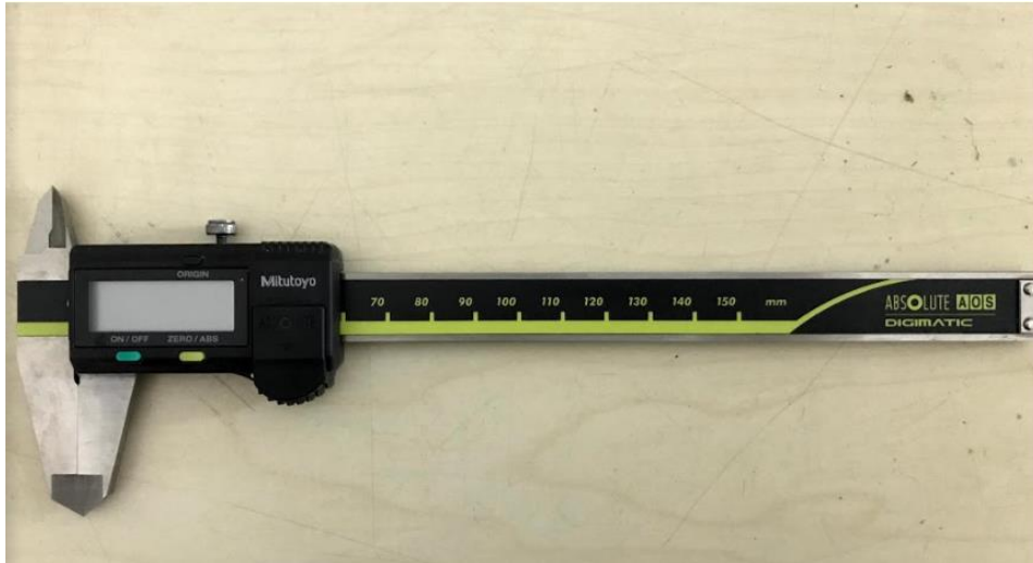
Slika 10. Digitalna pomična mjerka korištena u eksperimentu
