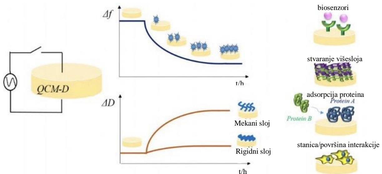
**Slika 3.** Shematski prikaz parametara koji se dobivaju QCM-D tehnikom i sustava koje se može analizirati i straživati (preuzeto iz Tonda-Turo i sur. 2018).
