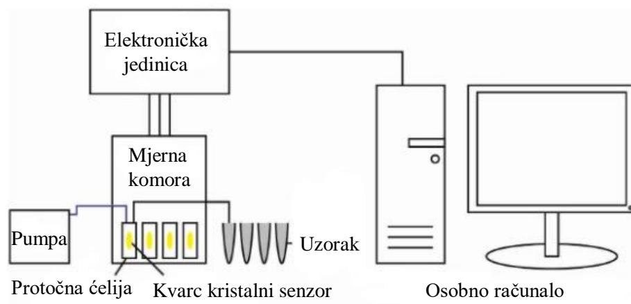
**Slika 9.** Shematski prikaz QCM-D instrumenta sa svojim sastavnim dijelovima. Preuzeto s: <https://www.nanoscience.com/techniques/quartz-crystal-microbalance/> (23.07.2020.)
