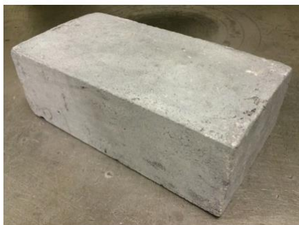
Slika 7. Eco-BLAC opeka od pepela i prašine proizvedena je uz pomoć alkalno-aktivacijske tehnologije, pri čemu se pepeo kao aluminij-silikat kombinira s alkalnom aktivacijskom otopinom ( URL4 ).
