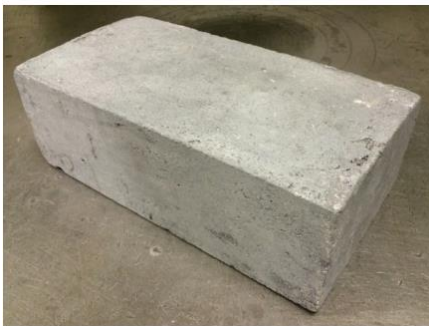
Slika 7. Eco-BLAC opeka od pepela i prašine proizvedena je uz pomoć alkalno-aktivacijske tehnologije, pri čemu se pepeo kao aluminij-silikat kombinira s alkalnom aktivacijskom otopinom ( URL4 ).
