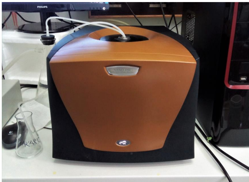
Slika 9. Mikrokalorimetar Nano-DSC, TA Instruments, New Castle, USA (fotografirano u Laboratoriju za biomolekularne interakcije i spektroskopiju Zavoda za organsku kemiju i biokemiju IRB-a.
