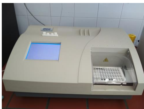
Slika 16. Kolorimetra MRC korišten za analizu glutena metodom ELISA.
