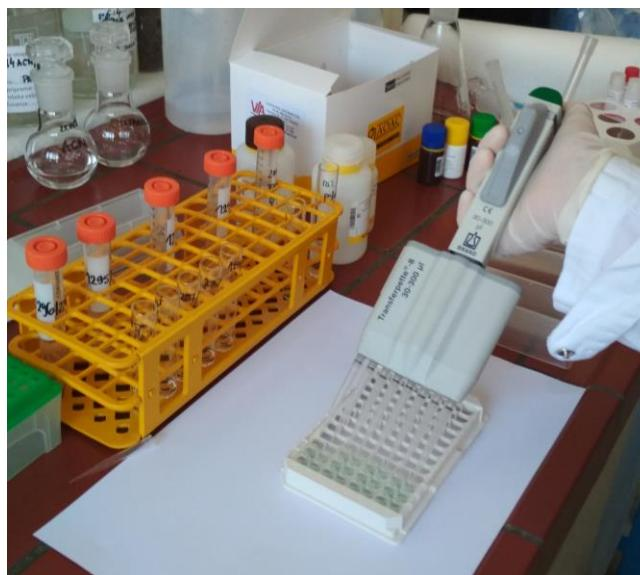
**Slika 15.** Multikanalna mikropipeta za dodavanje reakcijskih otopina.
