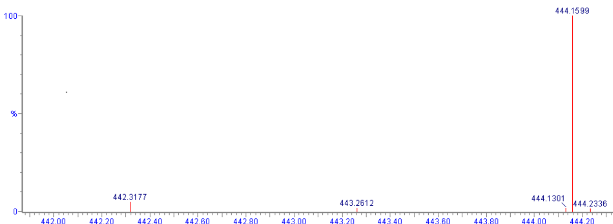
Slika D3. Spektar masa MS/MS i bodovna tablica elementne analize rosuvastatina A za m/z 444,1599. U bodovnoj tablici crvenom bojom je označen odabrani najvjerojatniji rezultat dobiven pretragom pomoću izračuna točne mase i usporedbe specifičnih izotopa.
