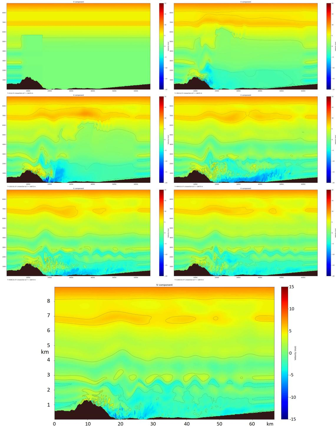
Slika 17 *XZ presjek sedam izdvojenih trenutaka simulacije nakon 0 s, 820 s, 1640 s, 4510 s, 9050 s, 13600 s, 18000 s (s lijeva na desno prema niže).* *V komponenta brzine u m/s prikazana je bojama, dok je zacrnjeno područje ispod površine zemlje.* *Sinoptički vjetar puše u smjeru osi x na grafu (s lijeva na desno).*
