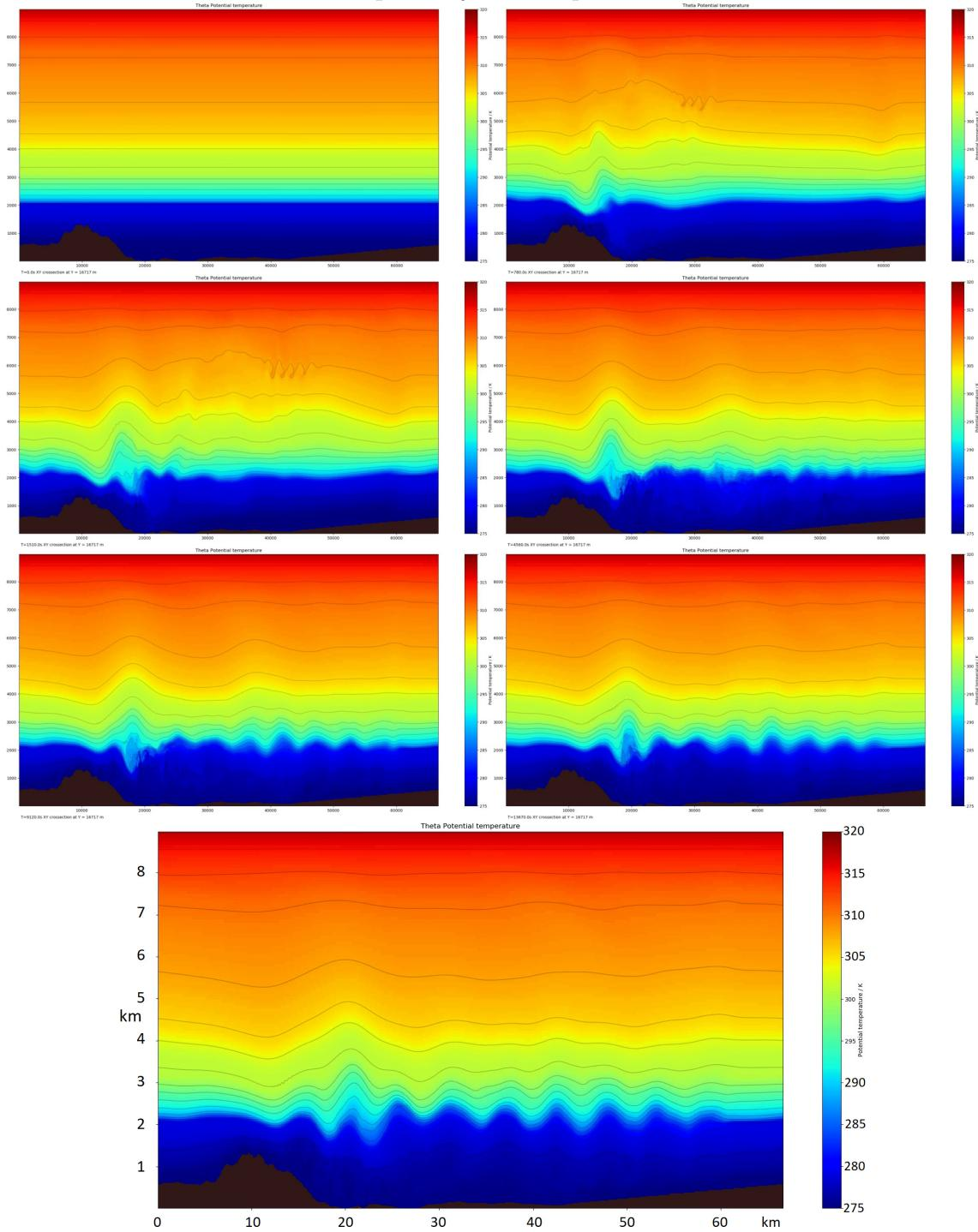
Slika 15  $XZ$  presjek sedam izdvojenih trenutaka simulacije nakon 0 s, 820 s, 1640 s, 4510 s, 9050 s, 13600 s, 18000 s (s lijeva na desno prema niže).  $\theta$  u K prikazana je bojama, dok je zacrnjeno područje ispod površine zemlje. Sinoptički vjetar puše u smjeru osi x na grafu (s lijeva na desno).
