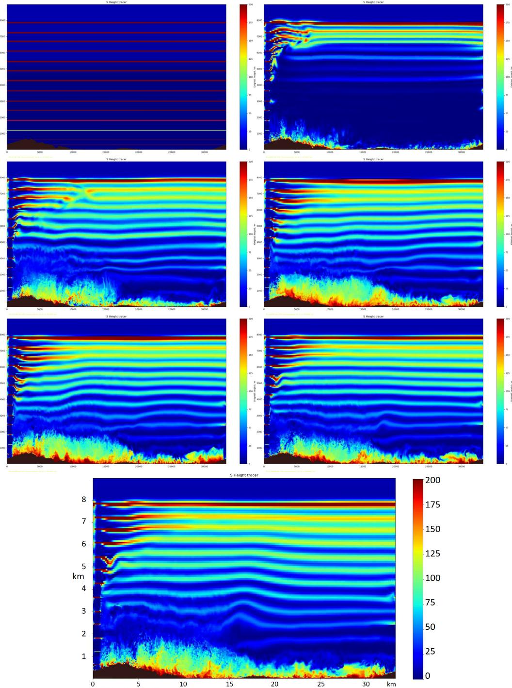
Slika 24  $YZ$  presjek sedam izdvojenih trenutaka simulacije nakon 0 s, 820 s, 1640 s, 4510 s, 9050 s, 13600 s, 18000 s (s lijeva na desno prema niže). S prikazan je bojama, dok je zacrnjeno područje ispod površine zemlje. Sinoptički vjetar puše u smjeru osi  $z$  na grafu (prema čitatelju).
