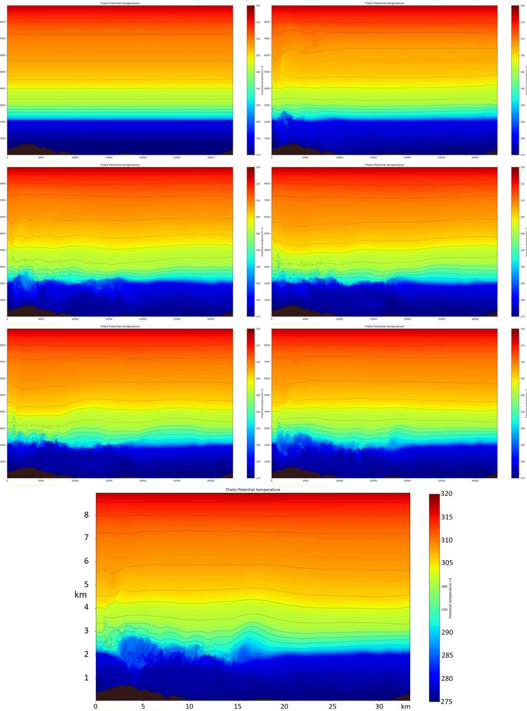
Slika 20  $YZ$  presjek sedam izdvojenih trenutaka simulacije nakon 0 s, 820 s, 1640 s, 4510 s, 9050 s, 13600 s, 18000 s (s lijeva na desno prema niže).  $\theta$  u K prikazana je bojama, dok je zacrnjeno područje ispod površine zemlje. Sinoptički vjetar puše u smjeru osi  $z$  na grafu (prema čitatelju).
