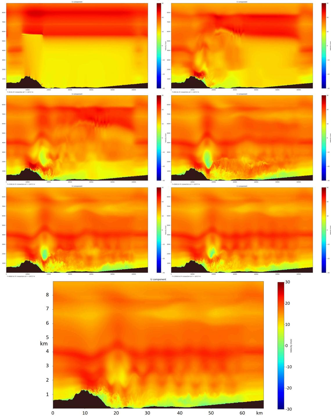
Slika 16  $XZ$  presjek sedam izdvojenih trenutaka simulacije nakon 0s, 820s, 1640s, 4510s, 9050s, 13600s, 18000s (s lijeva na desno prema niže). U komponenta brzine u m/s prikazana je bojama, dok je zacrnjeno područje ispod površine zemlje. Sinoptički vjetar puše u smjeru osi x na grafu (s lijeva na desno).
