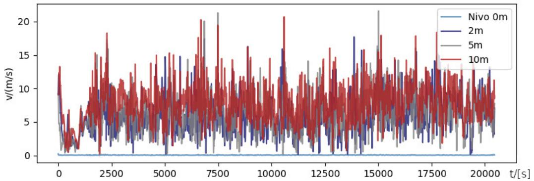
Slika 28 *Apsolutna simulirana brzina na 3 nivoa (2, 5, 10 m) u m/s za simulirani slučaj bure 30.12.*
