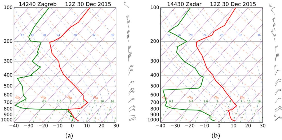
Slika 7 Profil temperature i vjetra mjereni radiosondažom 30.12.2015. u 12h UTC.
