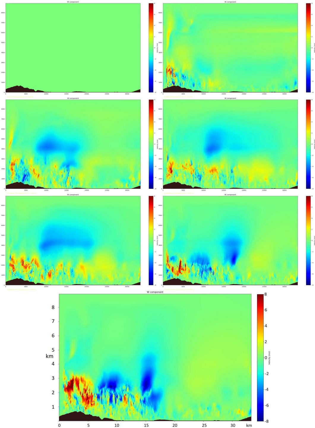
Slika 23  $YZ$  presjek sedam izdvojenih trenutaka simulacije nakon 0 s, 820 s, 1640 s, 4510 s, 9050 s, 13600 s, 18000 s (s lijeva na desno prema niže).  $W$  komponenta brzine u  $m/s$  prikazana je bojama, dok je zacrnjeno područje ispod površine zemlje. Sinoptički vjetar puše u smjeru osi  $z$  na grafu (prema čitatelju).
