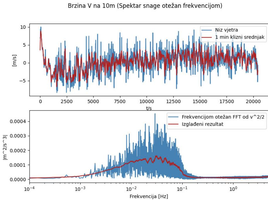
Slika 34 *Frekventno otežan Fourierov spektar simulirane V komponente brzine na visini od 10 m za simulirani slučaj bure 30.12.*
