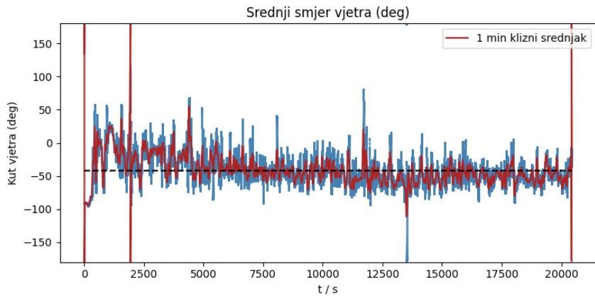
Slika 26 *Simulirani smjer vjetra u zakrenutom (simuliranom) koordinatnom sustavu za simulaciju slučaja bure 30.12. Plavom linijom crtamo svaki podatak, dok crvenom linijom izglađujemo mjerena minutnim kliznim srednjakom. Srednji smjer vjetra iznosi  $-41^\circ$ .*
