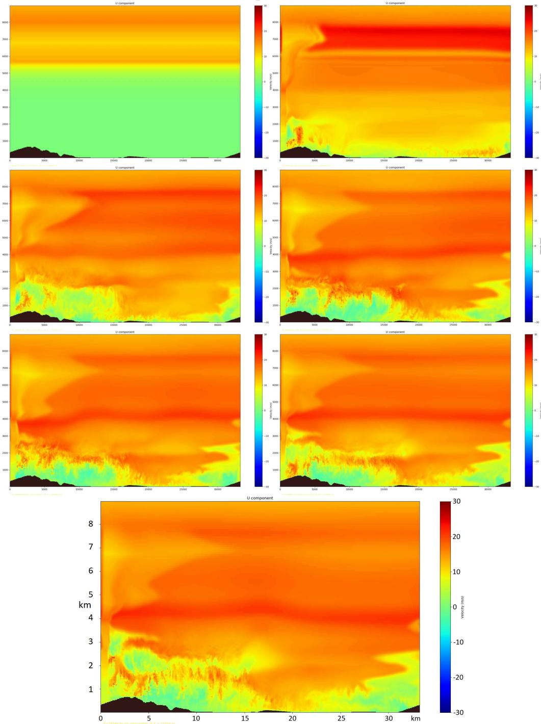
Slika 21  $YZ$  presjek sedam izdvojenih trenutaka simulacije nakon 0 s, 820 s, 1640 s, 4510 s, 9050 s, 13600 s, 18000 s (s lijeva na desno prema niže).  $U$  komponenta brzine u m/s prikazana je bojama, dok je zacrnjeno područje ispod površine zemlje. Sinoptički vjetar puše u smjeru osi  $z$  na grafu (prema čitatelju).
