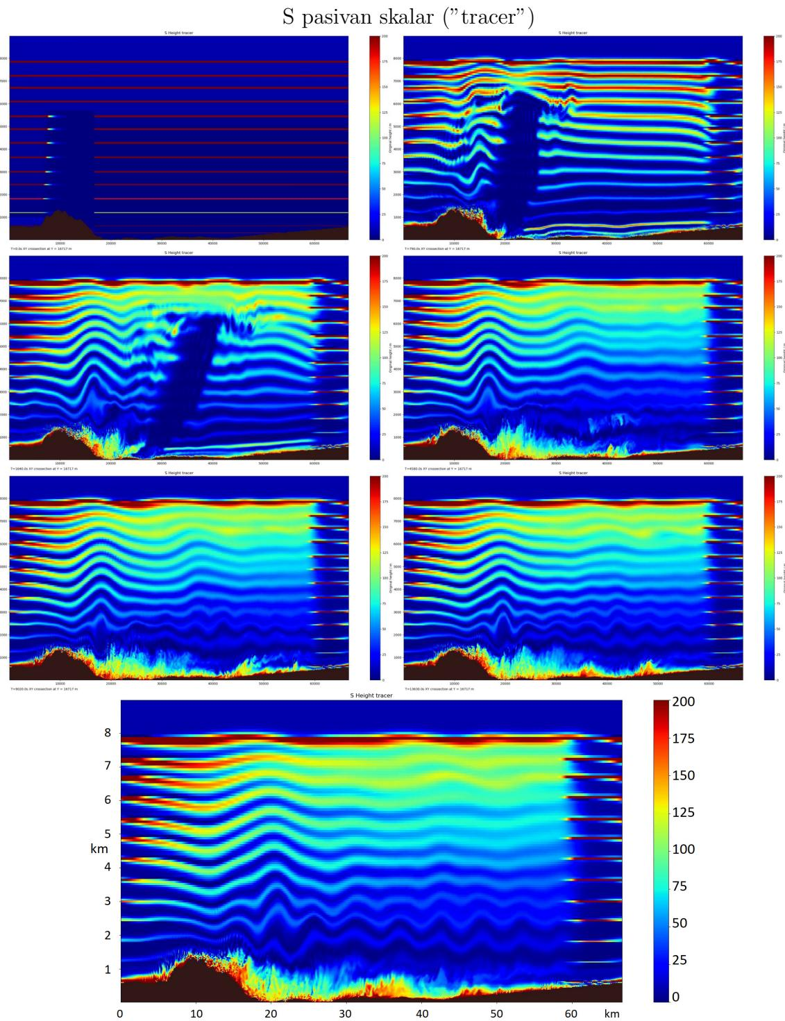
Slika 19  $XZ$  presjek sedam izdvojenih trenutaka simulacije nakon 0 s, 820 s, 1640 s, 4510 s, 9050 s, 13600 s, 18000 s (s lijeva na desno prema niže). S prikazan je bojama, dok je zacrnjeno područje ispod površine zemlje. Sinoptički vjetar puše u smjeru osi x na grafu (s lijeva na desno).
