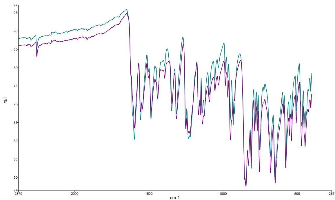
Slika D28. Usporedba IR spektara [\text{MoO}_2\text{L}^2(\text{MeOH})] izloženog parama \text{CH}_3\text{CN} (zeleno) i [\text{MoO}_2(\text{L}^2)]_n \times \text{CH}_3\text{CN}; \text{H}_2\text{L}^2 iz EtOH (ljubičasto).
