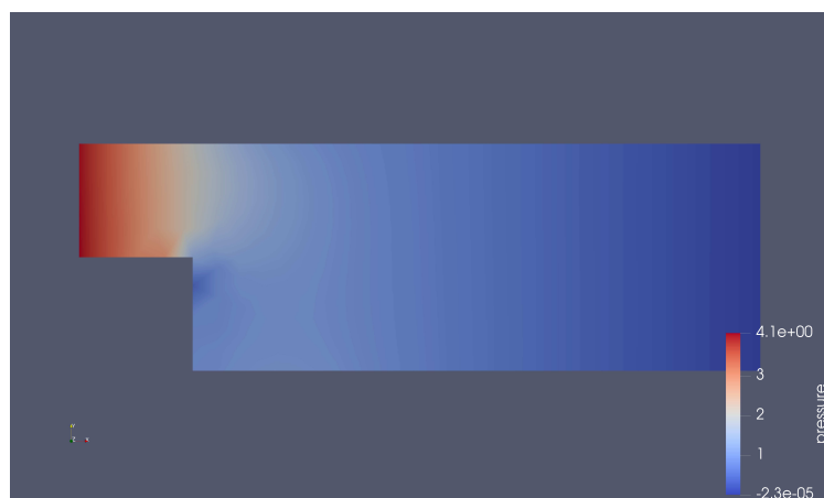
Slika 3.5: Optjecanje stepenice — tlak
