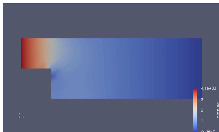
Slika 3.5: Optjecanje stepenice — tlak
