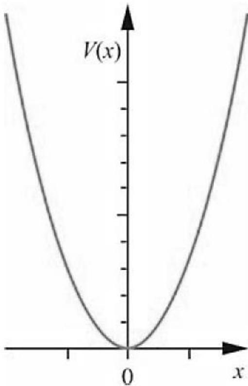
**Slika 3.** Potencijalna energija klasičnog harmoničkog oscilatora.<sup>8</sup>
