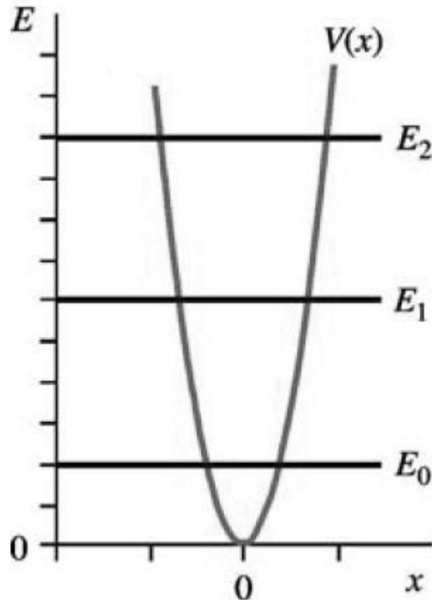
**Slika 4.** Shema energetskih razina za paraboličnu aproksimaciju kvantno-mehaničkog harmoničkog oscilatora.<sup>8</sup>
