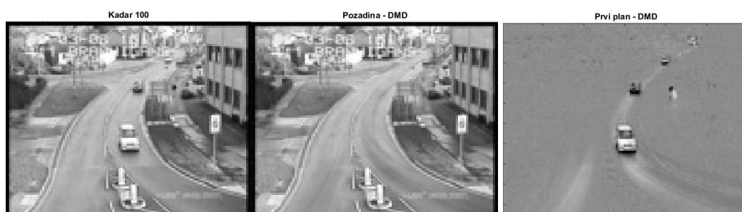
Slika 4.10: Na gornjim slikama prikazan je kadar broj 100 u videu i njegova separacija na pozadinu i prvi plan dobivena DMD algoritmom, kao parametar redukcije dimenzije uzeli smo r = 2 .
