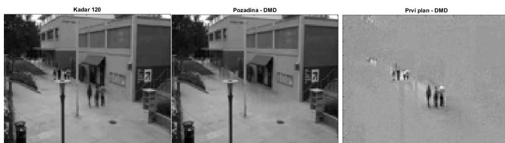
Slika 4.8: Na gornjim slikama prikazan je kadar broj 120 u videu i njegova separacija na pozadinu i prvi plan dobivena DMD algoritmom.
