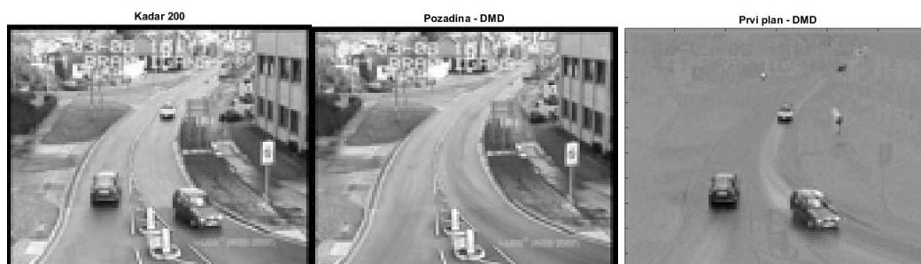
Slika 4.12: Na gornjim slikama prikazan je kadar broj 200 u videu i njegova separacija na pozadinu i prvi plan dobivena DMD algoritmom.
