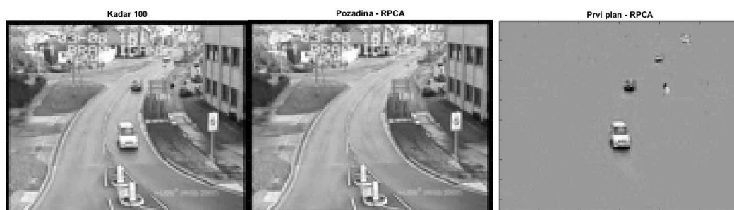
Slika 4.11: Na gornjim slikama prikazan je kadar broj 100 u videu i njegova separacija na pozadinu i prvi plan dobivena RPCA algoritmom.
