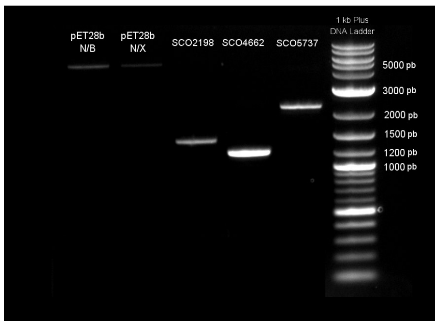
Slika 13. Gel elektroforeza razgrađenog vektora pET28b te razgrađenih PCR produkata. U prvoj i drugoj jažici nalaze se uzorci vektora pET28b razgrađeni restrikcijским enzimima NdeI/BamHI i NdeI/XhoI . U preostale tri jažice nalaze se razgrađeni PCR produkti kodirajućih sljedova za proteine SCO2198, SCO4662 i SCO5737.
